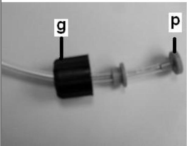
**I** La connessione del tubo in PVC 4x6 al raccordo **a** e del tubo 4x6 in PE al raccordo **m** della figura 1 è molto semplice. Far passare il tubo attraverso la ghiera, quindi il ferma tubo ed infine infilare il tubo nel raccordo **p** ed avvitare la ghiera **g** come in figura 3
