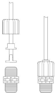
**I** Collegare l'altro capo del tubo PVC 4x6 al raccordo 1/2" e l'altro capo del tubo PE 4X6 alla valvola iniezione nella maniera che segue . Svitare la ghiera dal raccordo e far passare il tubo attraverso la ghiera, quindi il ferma tubo ed infine inserire con un'azione contemporanea di pressione e rotazione il tubo fino in fondo sull'attacco conico del raccordo (portagomma); bloccare il tutto serrando a fondo la ghiera.
