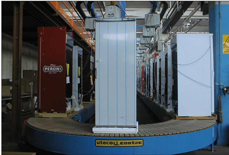
Foto 7 – linea di completamento, controllo estetico e collaudo funzionale dei frigoriferi.
