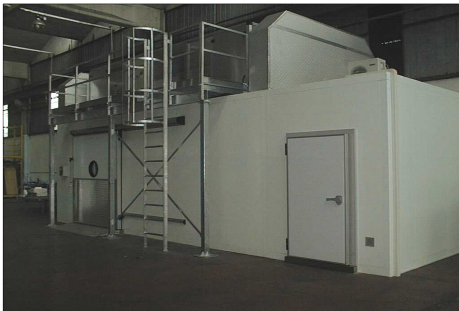
Foto 6 – camera climatica per le prove di funzionalità di apparecchi refrigeranti.
