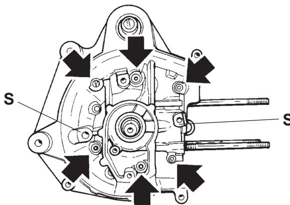
Mettere in tensione l'attrezzo separatore carter fissandolo sui due supporti di fusione (S, figura sopra) con filetto M8.
