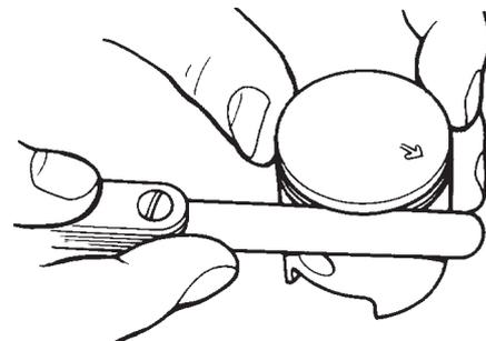
Controllare che i segmenti non presentino anomalie di alcun genere e che la distanza tra le estremità sia compresa nei valori indicati nella tabella seguente. Il controllo deve essere fatto con uno spessimetro introducendo il segmento nel cilindro e facendo attenzione a disporlo orizzontalmente. Per fare questo, posizionare i segmenti nel cilindro utilizzando la parte inferiore del pistone.
