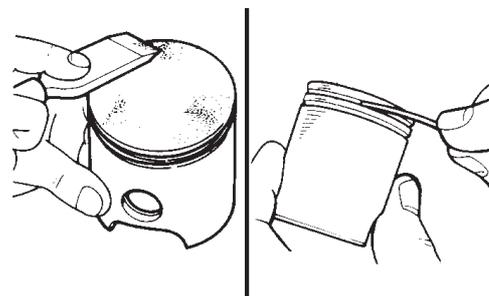
Ispezionare accuratamente il mantello del pistone. Se si riscontra la presenza di depositi di carbonio duro, occorre eliminarli immergendo l'intero pistone in un appropriato liquido come quello per la pulizia dei carburatori.
