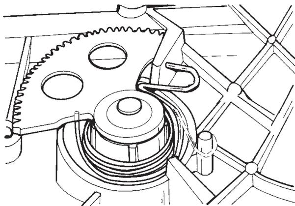
Rimontare in sequenza l'ingranaggio pignone e la molla, muovendo leggermente l'albero del pedale in modo da facilitare l'inserimento dell'ingranaggio.
