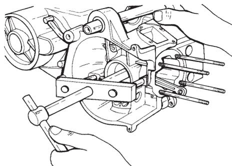
Rimuovere l'albero a gomito tramite l'attrezzo separatore fissandolo sui due supporti di fusione con filetto M8.
