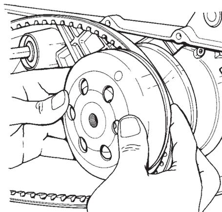
Rimuovere il dado fissaggio frizione, dopo aver compresso il gruppo mediante il supporto molla frizione.
