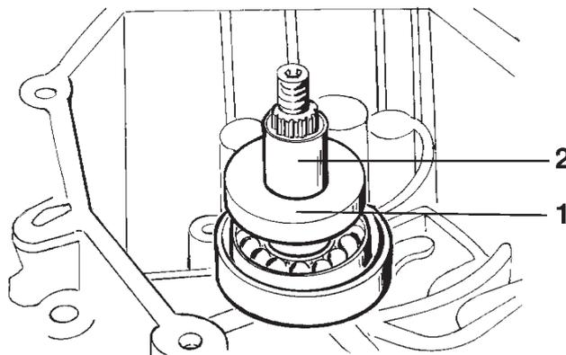
Per facilitare il montaggio utilizzare un tubo di diametro adeguato.
