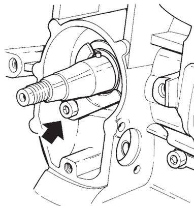
Montare in sequenza il seeger, il perno, l'ingranaggio conduttore pompa e l'altro seeger.
