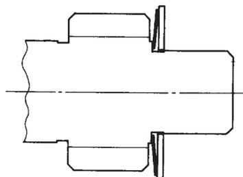
Prima di procedere al rimontaggio della scatola ingranaggi, lubrificare il cuscinetto dell'albero uscita moto, con olio motore (vedi Tabella Lubrificanti). Ingrassare inoltre la guarnizione del coperchio con grasso al sapone di litio (vedi Tabella Lubrificanti). Montare quindi la guarnizione, inserire le spine negli alloggiamenti, posizionare il coperchio trasmissione con l'albero uscita moto e serrare le 6 viti di fissaggio. Serrare la vite di scarico olio (1) con una nuova rondella (2).
