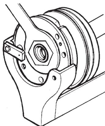
Per completare il montaggio frizione serrare il dado. Precaricare la molla di contrasto ed inserire la cinghia tra le puleggie per permettere l'inserimento del gruppo frizione nell'asse di entrata moto.
