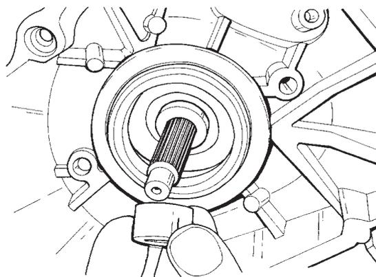
Montare in sequenza l'ingranaggio avviamento (1), applicando olio trasmissione, cuscinetto a rulli (2), frizione d'avviamento (3), rondella (4), ingranaggio di avviamento (5) lubrificato con olio, rondella (6) e fissare la piastrina (7) agendo sulle due viti (8) di fissaggio.
