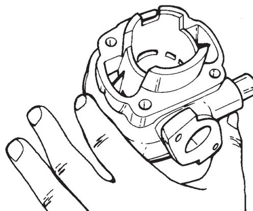
Misurare il diametro del cilindro con un alesometro rispettando i valori riportati nella tabella. Se la misura risulta fuori tolleranza, sostituire il cilindro, pistone ed i relativi anelli (vedi tabella accoppiamento).
