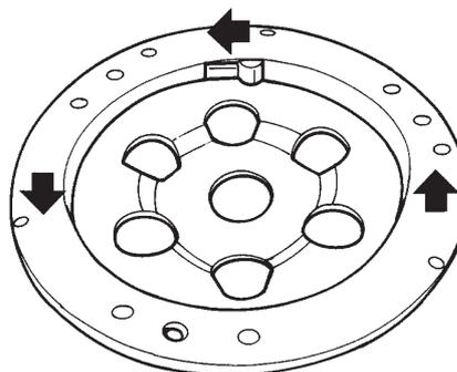
Controllare lo stato dei denti degli ingranaggi, la superficie interna ed esterna dell'ingranaggio (ruota d'avviamento) e del cuscinetto a rulli se presentano usura eccessiva o danni sostituire.
