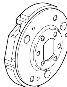
Misurare inoltre lo spessore dei ceppi (S) non superando il limite di usura di 2,5 mm.
