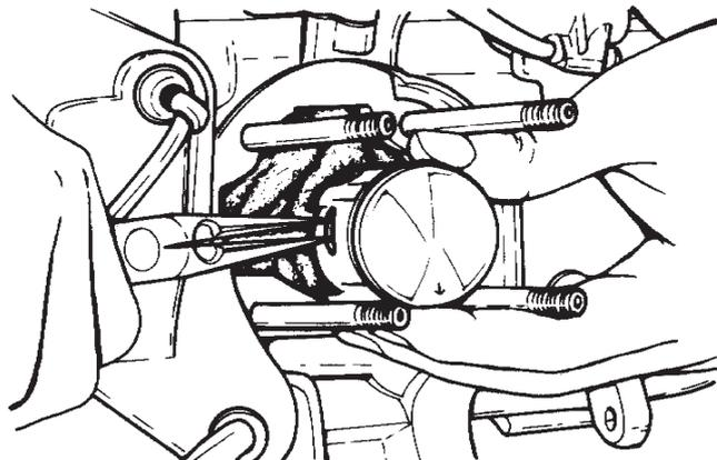
**▲ ATTENZIONE** Prima di montare il cilindro, applicare olio per motori a due tempi agli anelli pistone.
