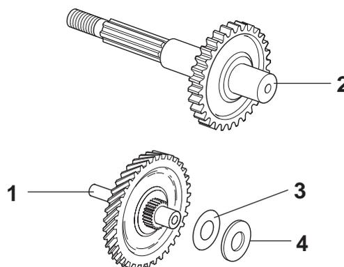
Montare correttamente la rondella molla conica come rappresentato in figura.
