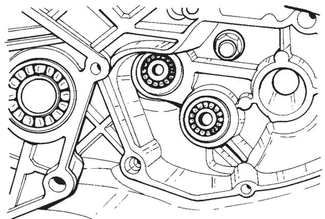
Controllare che l'albero di trasmissione scorra in modo omogeneo ed in caso di malfunzionamento riparare o sostituire.
