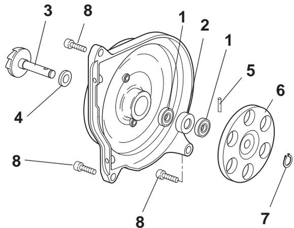
Montare il coperchio pompa acqua con il nuovo O-Ring e fissarlo al coperchio volano magnete mediante le 3 viti di fissaggio (1). Ricollegare i tubi di alimentazione e mandata acqua fissandoli con nuove fascette di tenuta.
