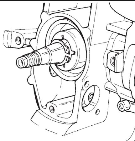
Rimontare la pompa, facendo particolare attenzione al passaggio tubo mandata olio e fissarla con le due viti.
