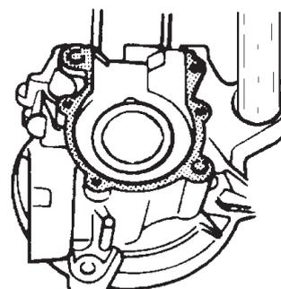
Scaldare il carter destro con riscaldatore automatico fino ad una temperatura di circa 150 °C, (~10 minuti di funzionamento), ed effettuare il definitivo montaggio dell'imbiellaggio nel carter destro, come descritto nel paragrafo successivo.
