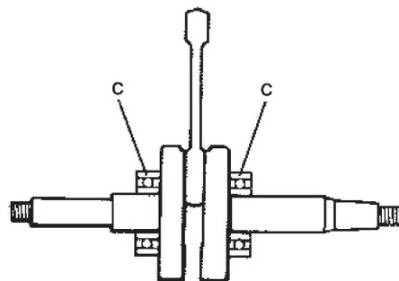
Scaldare il carter con riscaldatore automatico fino ad una temperatura di circa 150 °C, (~10 minuti di funzionamento), ed effettuare il piantaggio dell'imbiellaggio nel carter sinistro come descritto al paragrafo "Rimontaggio albero a gomito".
