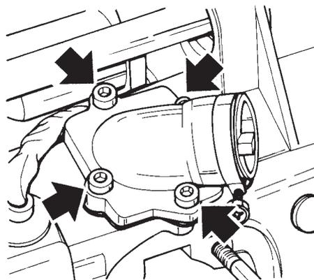
Smontare in sequenza il collettore di aspirazione (1), la valvola lamellare (2) e la relativa guarnizione (3) avendo cura di inserire nella fessura di aspirazione un panno in modo da evitare l'entrata di sporcizia ed il conseguente mal funzionamento dei meccanismi.
