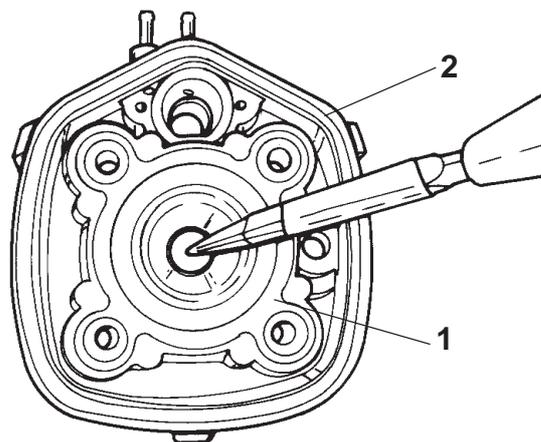
Ispezionare la camera di combustione della testa cilindro eliminando le incrostazioni.
