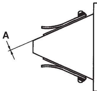
Misurare altezza fermi valvola lamellare (A). Se fuori tolleranza sostituire.
