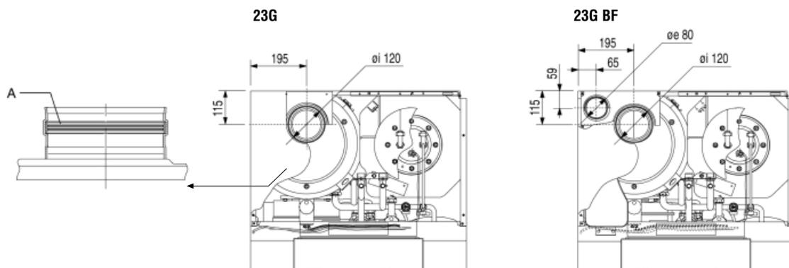
Il raccordo camino Øi è dotato di guarnizione di tenuta (A). Per realizzare il condotto di scarico non utilizzare i tubi con lembi sovrapposti graffiati.
