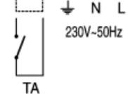
Quando si collega il termostato ambiente è necessario eliminare il ponte premontato (TA-TA).
