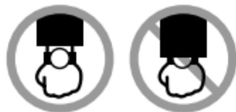
L'elettricità generata dalla cella solare dell'orologio viene accumulata da una pila incorporata. Se si lascia o se si usa l'orologio in luoghi in cui esso non è esposto alla luce, la pila si scarica. Accertarsi che l'orologio sia esposto il più possibile alla luce.
