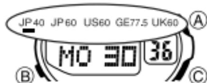
Durante la ricezione del segnale, l'indicatore del trasmettitore il cui segnale l'orologio sta tentando di ricevere lampeggerà. Dopo che la ricezione del segnale è terminata, l'indicatore del trasmettitore da cui il segnale è stato ricevuto rimarrà acceso, senza lampeggiare.
