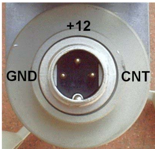
Fig. 9 – La disposizione dei fili sull' anemometro.
