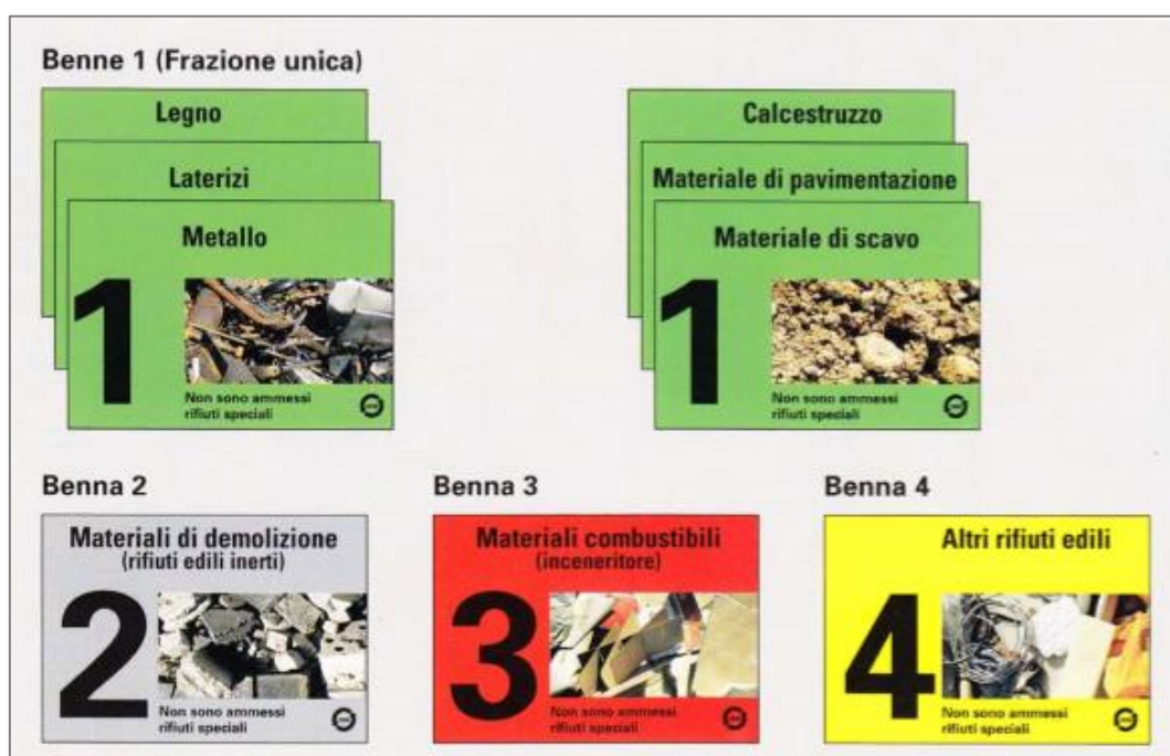
Figura 53: esempio di suddivisione delle benne secondo il “Concetto multibenne”
