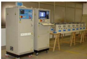
L'unità di controllo legge i dati raccolti dai box di acquisizione, li memorizza in un database, identifica il modello del prodotto leggendo il codice a barre, e confronta i dati letti con i dati di riferimento per il modello allo scopo di decidere se l'unità ha passato il test o no. Il risultato è mostrato sullo schermo e memorizzato nel database.
