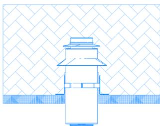
Inserire l'elemento nel foro precedentemente predisposto, e fissare le alette saldamente ai supporti della falda scelti e predisposti.
