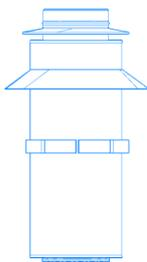
Posizionare il collare di fissaggio nella posizione centrale dell'Elemento.
