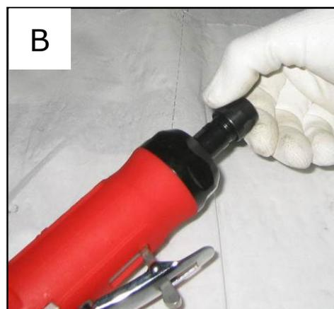
Figura 4 – Montaggio utensile (A: inserire la pinza – B: avvitare il mandrino).
