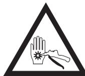
Questa pistola eroga fluido ad alta pressione. Il fluido erogato ad alta pressione potrebbe essere iniettato nella pelle e nel corpo, causando gravi danni, tra cui anche la necessità di amputazione. Inoltre, il fluido iniettato o spruzzato sugli occhi o sulla pelle può causare gravi ferite.
