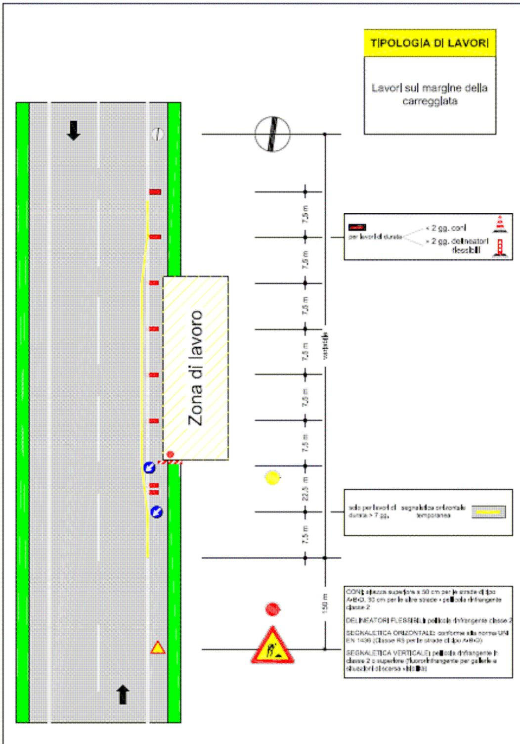
**ESEMPIO DISPOSIZIONE AREA DI CANTIERE PER CANTIERE MOBILE ASSISTITO DA MOVIERE**
