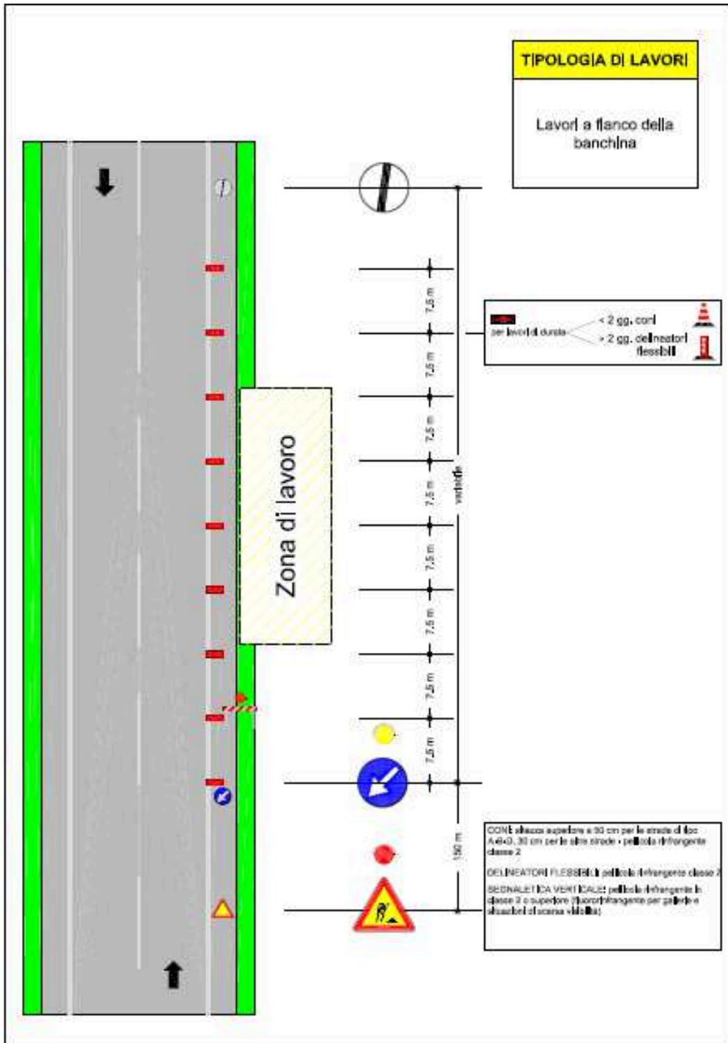
**ESEMPIO DISPOSIZIONE AREA DI CANTIERE PER LAVORI SUL MARGINE DELLA CARREGGIATA**
