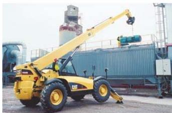
Mediante un braccio telescopico con dispositivi idraulici per la traslazione laterale, questi sollevatori consentono all'operatore di raggiungere punti di carico anche molto lontani dalla macchina, garantendo uno sbraccio notevole.
