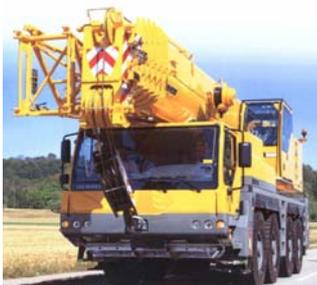
Costituito da una struttura scatolare in acciaio, resistente a sollecitazioni di torsione, il carro ha dimensioni di ingombro ridotte, al fine di consentire buone possibilità di manovra in qualsiasi terreno e in condizioni di spazi limitati.
