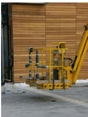
Costituita in struttura tubolare di acciaio, il cestello è confinato da ringhiere esterne con altezza di almeno 1,50 metri e fascia ferma – piedi perimetrale di circa 15 cm; a volte può essere dotata di un cancelletto con bloccaggio per facilitare l'ingresso nel cestello.
