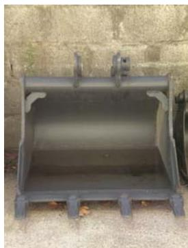
Utilizzata principalmente per la realizzazione di scavi di varia natura (trincee, fossati, fondazioni, ecc.), la benna consente di esportare materiale sciolto dal sito e trasportarlo e scaricarlo o su un punto di raccolta o direttamente sul cassone dell'autocarro.
