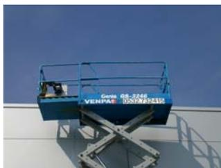
Costituita in tubolari di alluminio elettrosaldati, la piattaforma è confinata da ringhiere esterne con altezza di almeno 1,50 metri e fascia ferma – piedi perimetrale di 15 cm; a volte può essere dotata di un cancelletto con bloccaggio per facilitare l'ingresso nel cestello.
