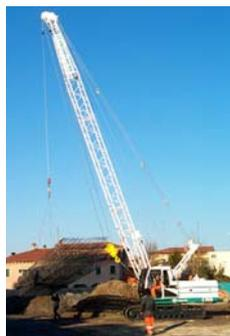
utilizzato per cantieri operanti in terreni impervi e con forti pendii, questo sistema è costituito da una coppia di cingoli aventi 15 rulli di scorrimento per lato (10 inferiori e 5 superiori), movimentati da un motore diesel.
