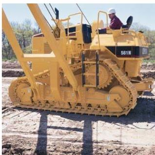
La struttura di trasporto della 561N, alimentata da un motore diesel a quattro tempi e sei cilindri e conforme alle normative sulle emissioni EPA, ha una configurazione standard di larghezza globale non troppo ingombrante ed è progettata appositamente per lavori su terreni morbidi e spugnosi, grazie all'adozione di ampi pattini dei cingoli che consentono un aumento della superficie di contatto e, conseguentemente, una riduzione della pressione sul terreno.
