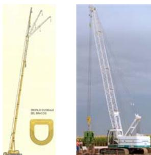
Il braccio, realizzato con elementi di acciaio ad alta resistenza, è sia telescopico (a struttura ovoidale) che tralicciato (a tubi saldati) a seconda dei modelli di gru, ed è vincolato alla zavorra mediante cavi di acciaio a trefoli avvolti in spire all'organo di sollevamento.
