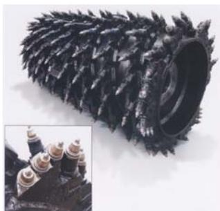
Posto nella parte sottostante del carro, proprio al di sotto della cabina, il rotore è composto da una struttura cilindrica di acciaio ad alta resistenza con 178 utensili conici con punte in carbonio.
