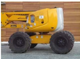
La capacità di mobilitazione del carro è garantita da 4 ruote motrici aventi pneumatici sterzanti a comandi simultanei che consentono di operare in qualsiasi condizione stradale, superando pendenze fino al 50 %.
