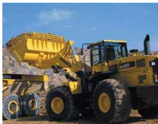
Dotata di una benna intercambiabile a seconda delle necessità, la pala gommata consente un'ampia gamma di applicazioni cantieristiche che vanno dalla cava sino al trasporto di legname.
