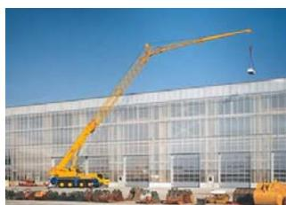
utilizzato per cantieri che operano soprattutto in zone urbane, ad alta probabilità di traffico pedo – veicolare, questa mobilitazione è garantita da 4 assi autosterzanti gommati posti su un trattore a dimensioni ridotte.
