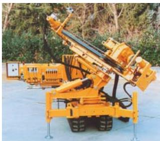
La movimentazione è composta da due cingoli gommati di 23,5 centimetri di larghezza, che consentono di avere una buona superficie di appoggio ed evitano l'affondamento del mezzo.
