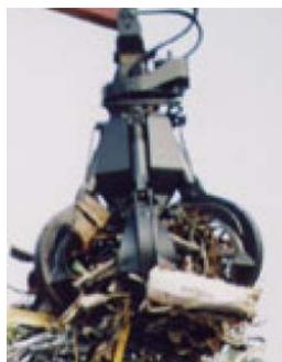
Utilizzata principalmente per la mobilitazione di materiale ingombrante, la Pinza idraulica è un attrezzo che può essere utilizzato non solo in cantieri edili ma anche industriali (per carico – scarico materiale).
