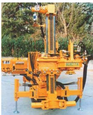
Realizzata con piastre di acciaio bullonate e saldate, la struttura posa – tubi presenta una testa di rotazione che scorre su di una catena a triplice filo di anelli, agganciata ad essa mediante piastre di acciaio.
