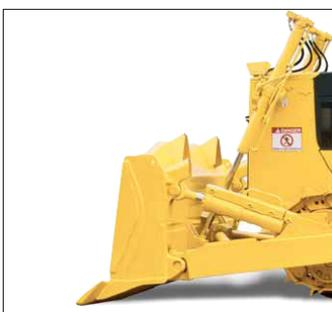
Costituita con acciaio ad alta resistenza, al fine di limitare l'usura e aumentare la durata, la lama ha un profilo studiato in maniera tale da accoppiare una buona penetrazione al suolo unita ad una bassa resistenza al rotolamento del materiale.
