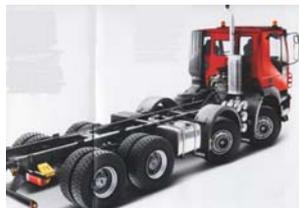
Costituito in acciaio ad elevato limite di snervamento, è composto da “longheroni” ,con sezione a C, di 10 mm di spessore, collegate tra loro da traverse intermedie chiodate.
