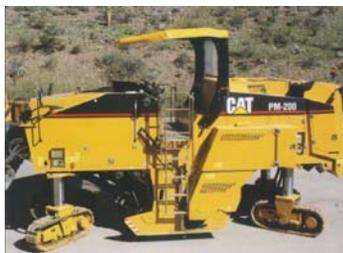
La movimentazione è composta da quattro cingoli dotati di pattini in poliuretano di circa 1,50 metri di lunghezza, ciascuno dei quali è dotato di un sistema di regolazione di altezza a pistoncini idraulici che consente una buona stabilità e maggior sicurezza.
