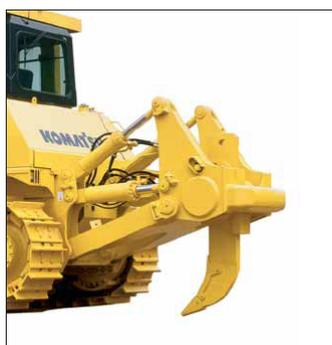
Costituita in struttura di acciaio, presenta uno o più denti rivestiti con apposite protezioni antiusura, così da garantire una buona durata oltre a permettere una miglior penetrazione nei diversi materiali.
