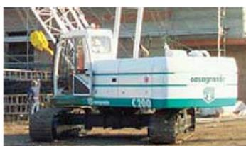
Un sistema di sospensioni idropneumatiche, regolabili elettronicamente, consentono di mantenere le condizioni di sicurezza operativa in qualsiasi terreno.
