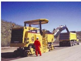
Grazie ad un rotore posto nella parte inferiore del mezzo, la Scarificatrice è in grado di rimuovere strati di asfalto e di calcestruzzo fino a profondità elevate, così da consentire una pulizia più profonda degli strati di usura della sede stradale prima di posare quelli nuovi con la Vibrofinitrice.
