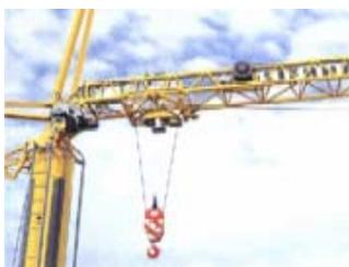
Il braccio, realizzato in traliccio di acciaio ad alta resistenza, è telescopico fino a quattro elementi, al fine di poter realizzare uno sbraccio utile di oltre 40 metri ed è vincolato alla zavorra mediante cavi di acciaio a trefoli avvolti in spire all'organo di sollevamento.
