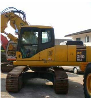
Composta dal motore e dalla cabina di manovra, la torretta rotante è realizzata con lamierato pesante al fine di conferire ottima robustezza e garantire sicurezza all'operatore anche in condizioni critiche (ad esempio: ribaltamento del mezzo).
