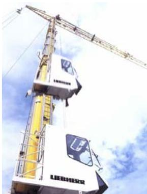
La torre è realizzata da un sistema scatolare a doppio sfilo telescopico a sviluppo verticale, composto da profili in acciaio saldati e resistenti a sollecitazioni a torsione; questa composizione consente di raggiungere altezze di lavoro elevate sempre mantenendo la sicurezza alla stabilità.
