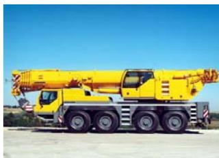
Progettate per il sollevamento e movimentazione di materiale anche pesante, si presentano in commercio con due diversi sistemi di mobilitazione, a seconda della tipologia di cantiere.
