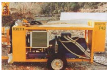
(se presente) Posizionato all'esterno del mezzo, il carro – motore è realizzato da una struttura scatolare in acciaio e da un sistema di mobilitazione gommata ad un solo asse.
