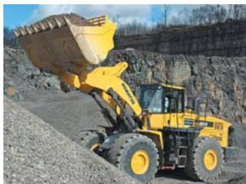
La Motoruspa, nota anche con il nome di pala gommata, è il mezzo maggiormente utilizzato in cantiere per il carico e il trasporto di materiale a terra.
