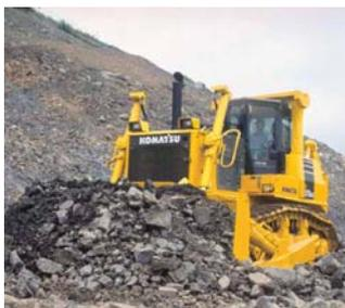
Adottata principalmente nei cantieri edili, l'apripista da la possibilità ad operai e a mezzi di poter giungere "in sicurezza" nelle zone interne del cantiere, realizzando aree di viabilità, ripulendole da ostacoli anche interrati e rendendole piane e compatte.
