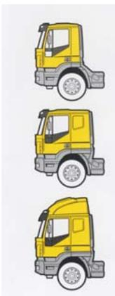
Composto da una serie di modelli specifici a seconda delle tratte di percorrenza (cabina “corta” o “lunga”, con uno o due lettini a seconda delle ore di percorrenza richieste), le cabine sono comunque tutte dotate di sospensioni autonome resistenti, al fine di assorbire adeguatamente le sollecitazioni dei terreni più irregolari.
