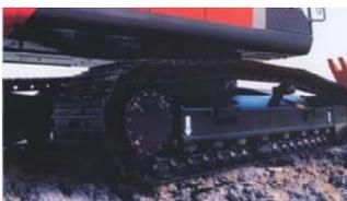
Costituito da un sistema a movimento cingolato con 2 rulli superiori e 8 inferiori, il sottocarro è studiato per superare qualsiasi tipologia di terreno anche con pendenze fino a 35°.
