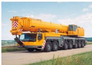
Le gru semoventi sono progettate per usufruire delle capacità di sollevamento dei carichi eliminando il problema della scelta del punto di appoggio che, in genere assilla le classiche gru a torre.
