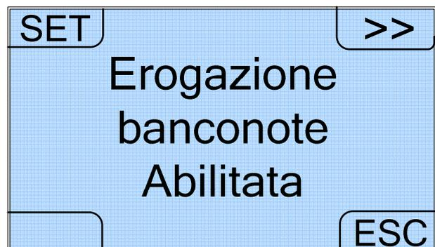
Come nel Menu Esterno, anche in questo caso, selezionando l'opzione SI e quindi l'opzione ESC, viene disattivata o attivata l'erogazione delle banconote. Le banconote continuano comunque ad essere accettate dall'apparecchio e vengono depositate nello stacker. Quando l'erogazione delle banconote è disattivata, occorre quindi disabilitare anche il cambio misto ed attivare il cambio standard (comandi CONF→password→CONF→CONF→STD→ESC). L'erogatore di banconote può
