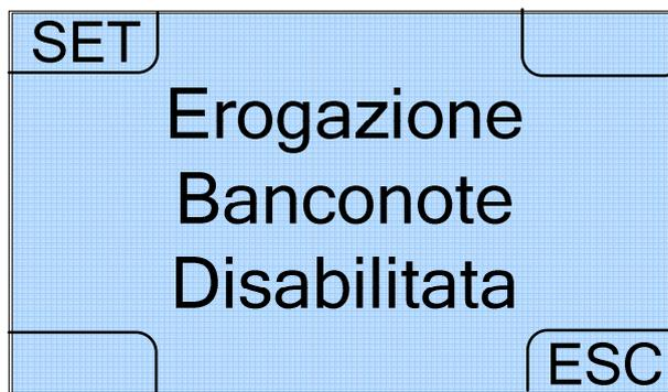
Selezionando l'opzione SET e quindi l'opzione ESC viene disattivata l'erogazione delle banconote. Le banconote vengono comunque accettate dall'apparecchio e vengono depositate nello stacker. Quando l'erogazione delle banconote è disattivata, occorre quindi disabilitare anche il cambio misto ed attivare il cambio standard (comandi CONF→password→CONF→CONF→STD→ESC). Questa impostazione può essere utile se, ad esempio, è presente un malfunzionamento nel ricircolo o nell'erogazione delle banconote.
