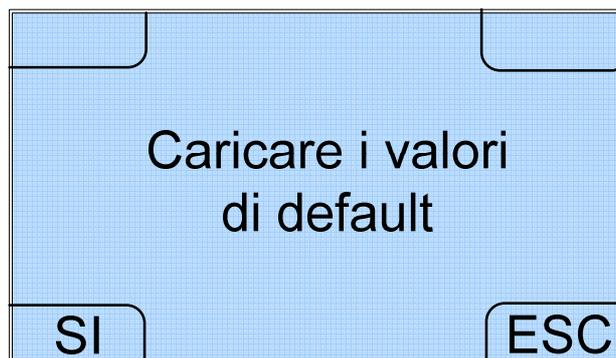
Nel caso si decida di procedere selezionando l'opzione SI, viene richiesto di inserire la password per il reset, che è la stessa utilizzata per l'accesso al Menu Setup Test e Manutenzione (quindi 111111, all'uscita dell'apparecchio dalla fabbrica).
