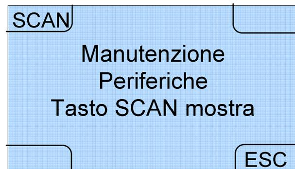
Come suggerisce la schermata Manutenzione Periferiche, è sufficiente selezionare l'opzione SCAN per accedere ad una serie di schede che mostrano lo stato di funzionamento delle varie periferiche, contrassegnate ognuna da un indirizzo (Smart Hopper Address 07, Payout Recycler Address 40, Gettoniera RM5 HD Address 02, Hopper Mono Address 06 )
