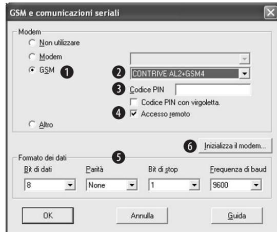
Spuntate [1] per abilitare l'uso del Modem GSM.
