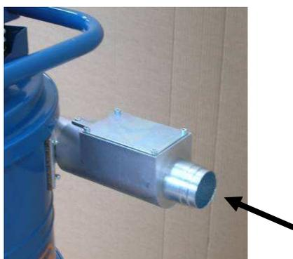
Collegare un'estremità del tubo flessibile con l'accessorio desiderato e l'altra con il bocchettone tangenziale montato sulla camera filtrante.
