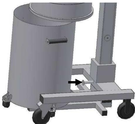
Guidare il fusto principale sulle pale del carrello spingendolo fino al fermo.
