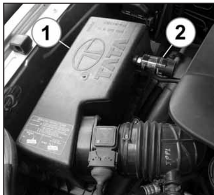
1. Filtro aria 2. Indicatore intasamento
