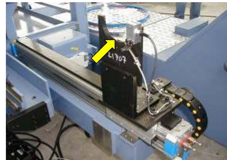
Controllo origini di cambio utensili tra preset e manipolatore
