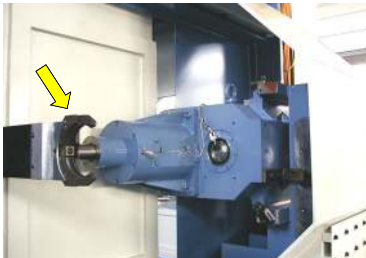
Controllo usura pinze scambio utensili su asse V
