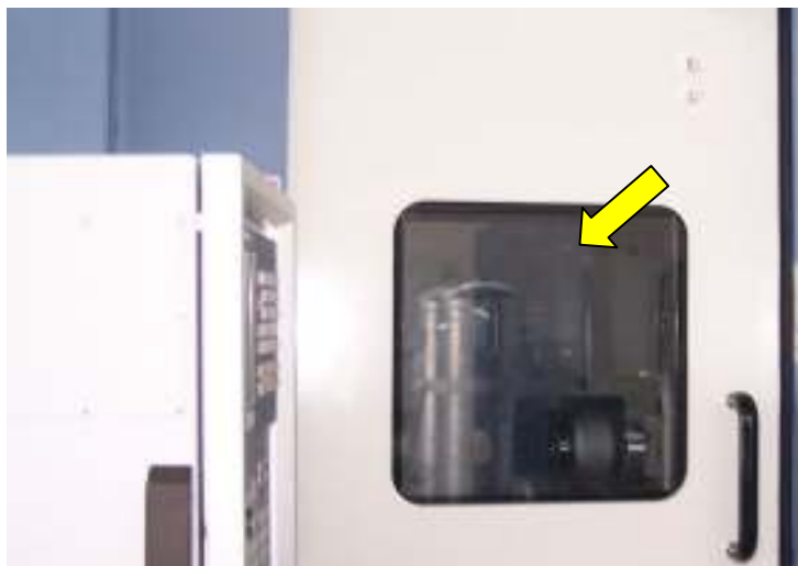
Sostituzione protezioni trasparenti in vetro temprato
