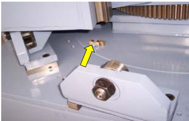
Manutenzione pattini guide carrello multipallet
