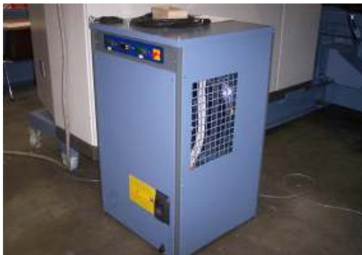
Verifica delle condizioni di funzionamento e pulizia del refrigeratore per liquido raffreddamento mandrino
