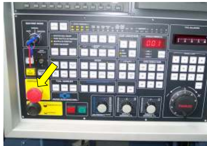
Pulsante d'EMERGENZA su pulsantiera al pulpito
