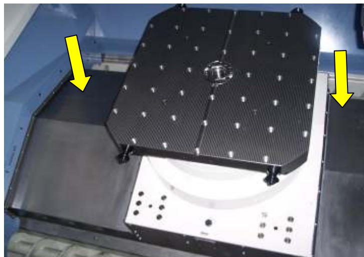
Controllo Raschiatori polveri-olio carter telescopici asse Z
