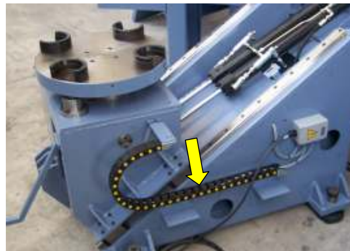
Catena flessibile portacavi su slitta porta pallet posto operatore per carico- scarico.
