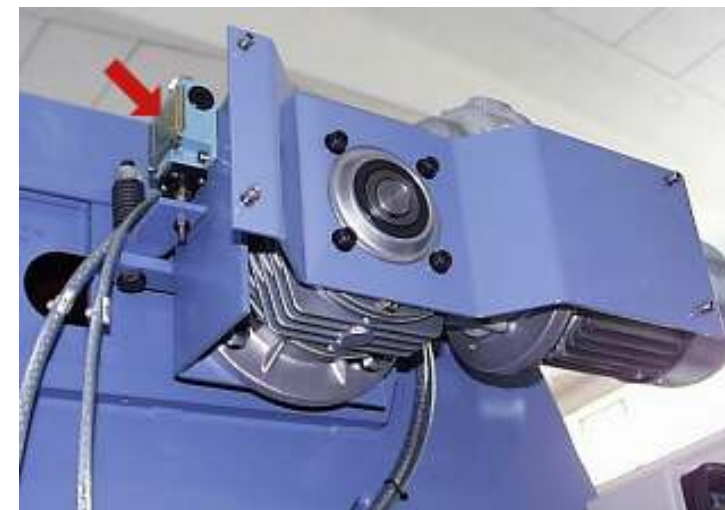
Controllo funzionamento micro su trasportatore trucioli
