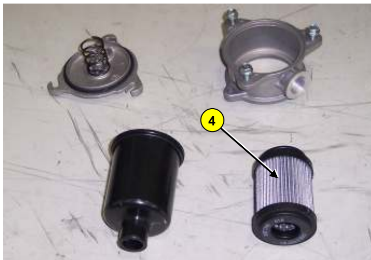
Particolari filtro smontato con elemento filtrante (4) da sostituire (foto indicativa)
