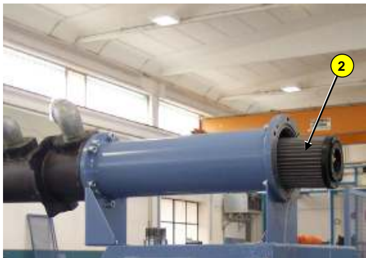
Pulizia, o eventuale sostituzione, filtri refrigerante alta pressione e refrigerante raffreddamento montante Macchina
