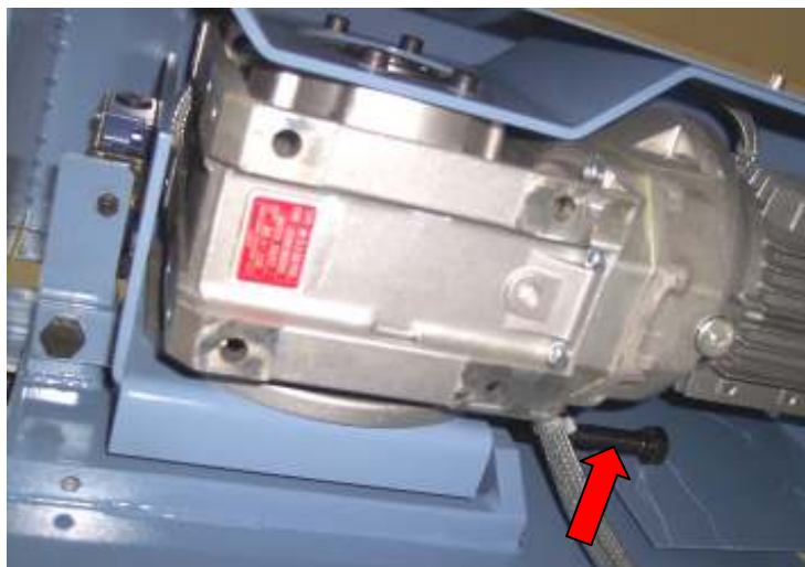
Tenditore catena raschiante trasportatore trucioli
