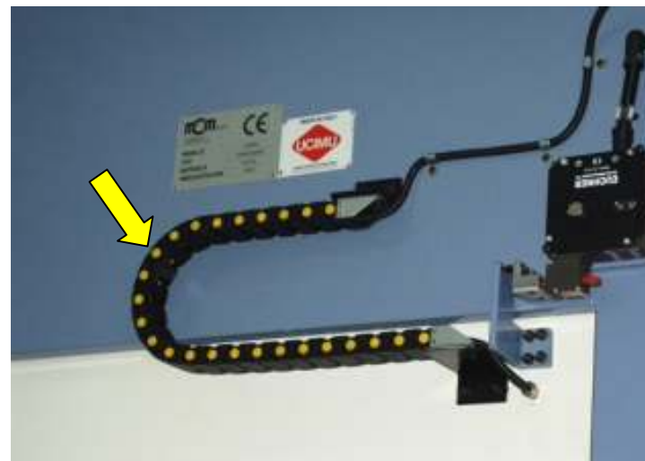
Catena flessibile portacavi per scorrimento portella posto operatore al pulpito
