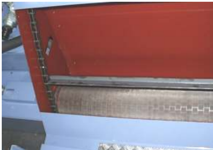
Controllo filtro a rete trasportatore trucioli
