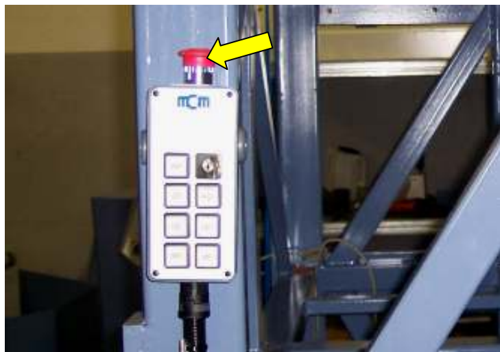
Pulsante d'EMERGENZA su pulsantiera comandi carrello multipallet
