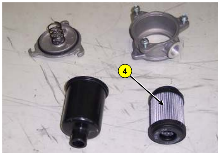
Particolari filtro smontato con elemento filtrante (4) da eventualmente sostituire
