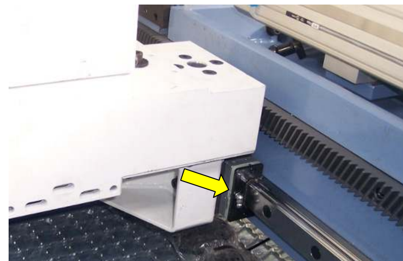
Manutenzione pattini guide manipolatore utensili (analogamente su lato opposto)
