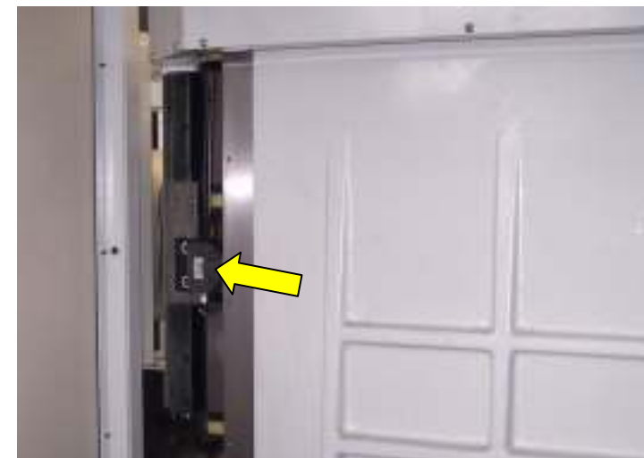
Controllo funzionamento micro fine corsa asse Y
