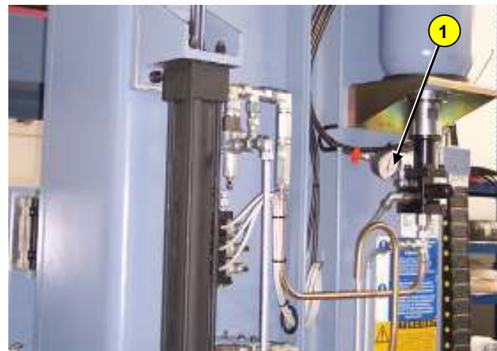
Manometro pressione impianto bilanciamento idraulico carrello multipallet
