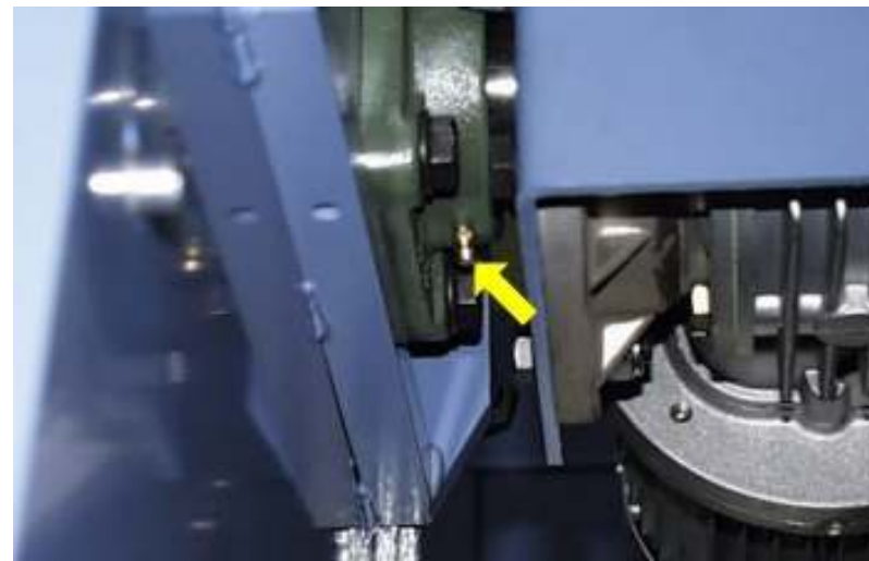
Ingrassaggio cuscinetti albero motore trasportatore trucioli
