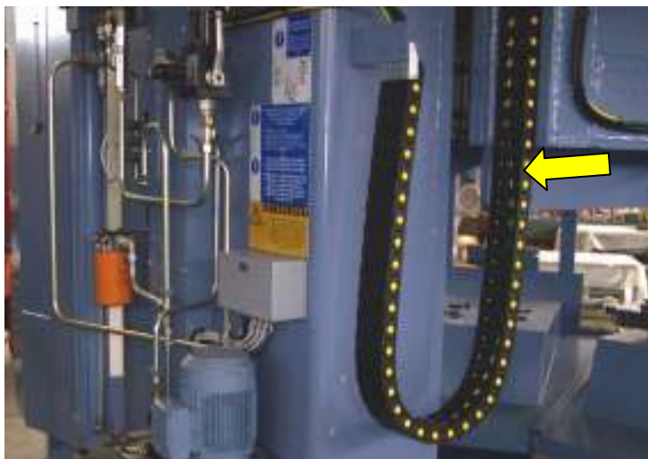
Catena flessibile portacavi per scorrimento slitta scambiatore pallet-giostra
