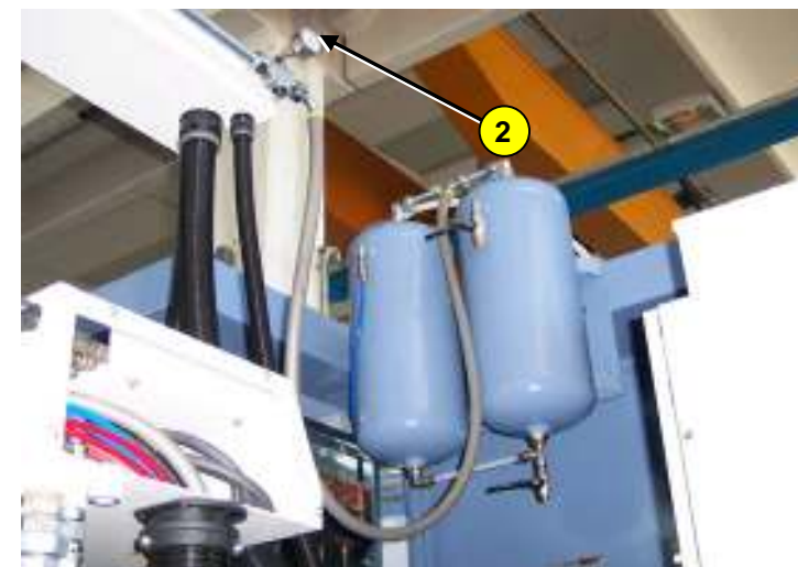
Manometro pressione accumulatori bilanciamento testa mandrino
