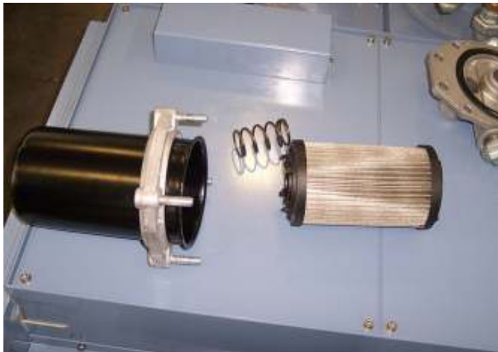
Particolari filtro smontato
