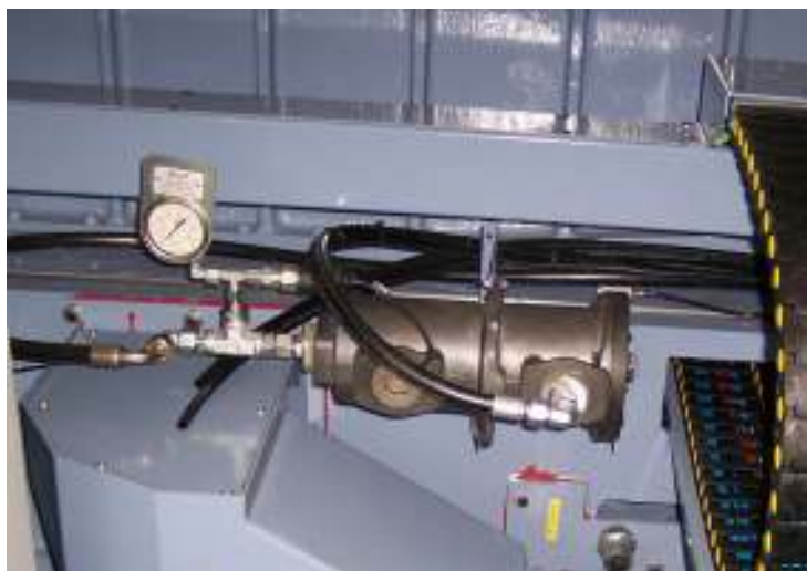
Pulizia, o eventuale sostituzione, filtri refrigerante linea ugelli mandrino a bordo macchina.
