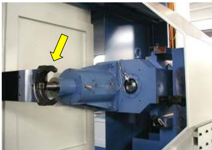
Controllo origini di cambio utensili tra braccio di scambio e mandrino
