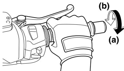
La regolazione della velocità avviene aprendo e chiudendo la manopola dell'acceleratore. Per aumentare la velocità, girare la manopola dell'acceleratore in direzione (a). Per ridurre la velocità, girare la manopola dell'acceleratore in direzione (b).
