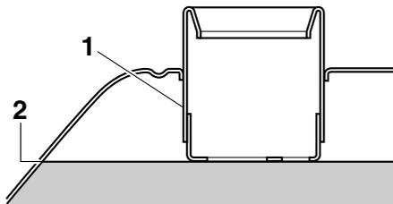
1. Tubo di rifornimento del serbatoio del carburante
