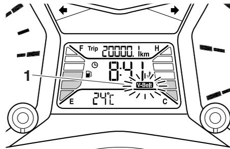
1. Indicatore di sostituzione cinghia trapezoidale "V-Belt"
