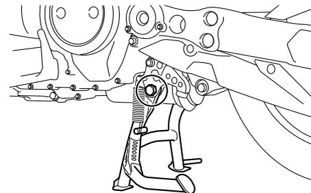
Prima di utilizzare il mezzo, controllare sempre il funzionamento del cavalletto centrale e del cavalletto laterale, e lubrificare, se necessario, i perni di guida e le superfici di contatto metallo/metallo.
