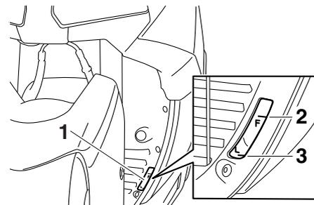
1. Oblò d'ispezione del livello del liquido refrigerante
