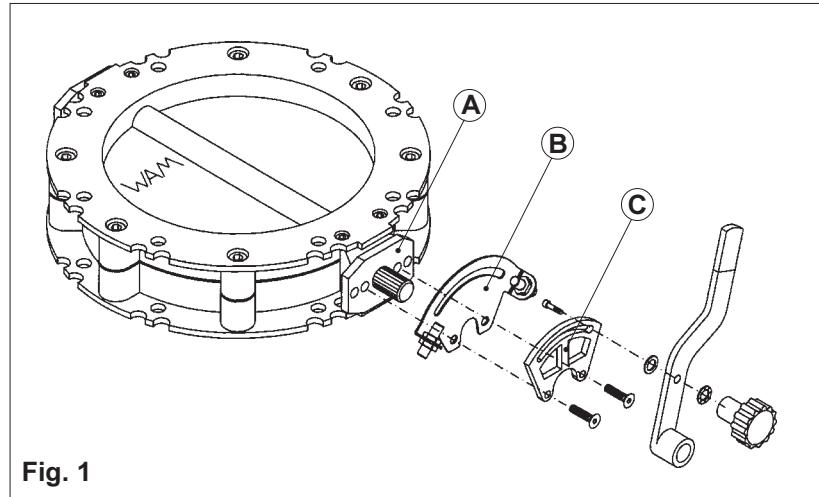
Los microinterruptores de tope inductivos, (XS1), véase Fig. 2, se deben fijar en los dos extremos de la placa (B) a una distancia mínima de la palanca de 0,8 mm.
