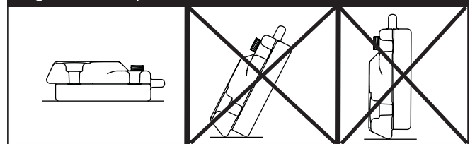
Figura 35 — Depósito de Combustible
