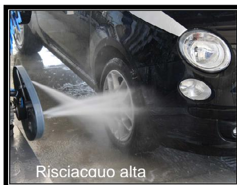
Quando il disco non è in prossimità dei cerchi il sistema **Discover** viene utilizzato per il prelavaggio in alta pressione laterale basso.
