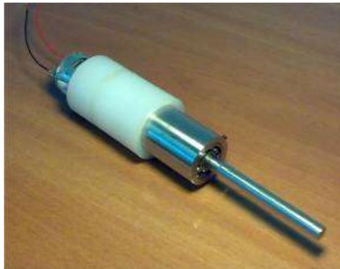
Figura 6. Prototipo di accoppiamento magnetico progettato e inserito nelle autoclavi
