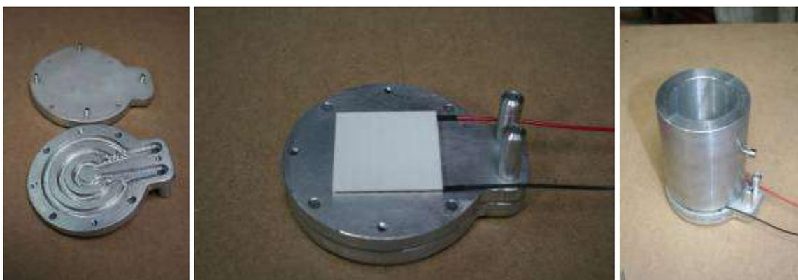
**Figura 8. Scambiatore di calore ad acqua per raffreddamento/riscaldamento Peltier.
