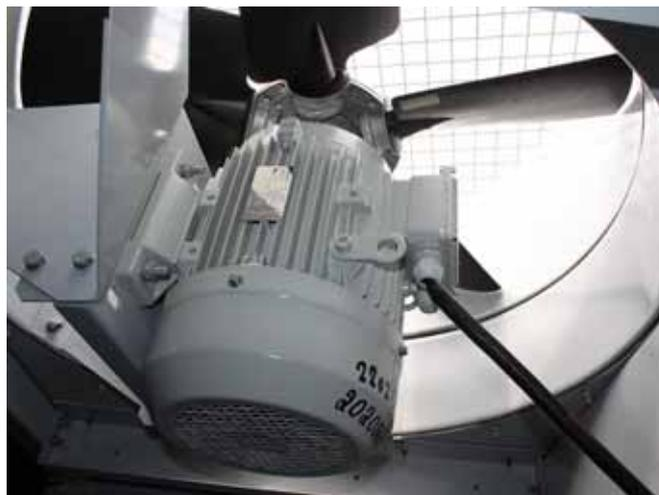
Figura 8: Sistema di trasmissione diretta
