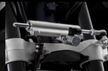
Ammortizzatore di sterzo a controllo elettronico
