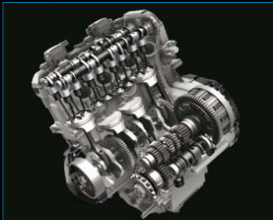
Motore 4 tempi, 4 cilindri, raffreddato a liquido
