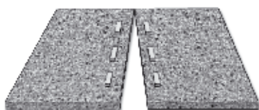
Blocchi fissati alla lastra
