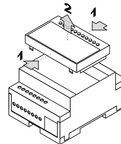
Scollegare l'alimentazione ed ogni circuito in tensione. Rimuovere il fronte per avere accesso all'interno:
