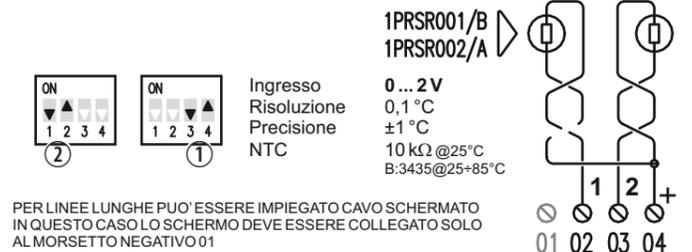
Sensori attivi con consumo inferiore a 50mA possono essere alimentati direttamente da GW-42 quando la tensione di alimentazione e l'uscita siano compatibili.
