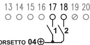
L'alimentazione esterna dei contatti deve essere conforme alle specifiche per circuiti SELV secondo EN60950 / IEC950: massima tensione ammissibile 60Vcc.
