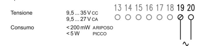
Un interruttore automatico bipolare (almeno 3mm di isolamento tra contatti aperti) che assicuri l'intervento in caso di cortocircuito e sovracorrente deve essere presente sul collegamento alla distribuzione di rete. Il collegamento tra EMG-A72-42 e la sorgente di alimentazione a bassa tensione non deve eccedere i 3 m.
