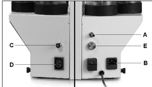
2. Inserire il raccordo ad innesto rapido sul ricettacolo maschio (A) montato sul lato destro della macchina e collegare il tubo di alimentazione pneumatica tipo in polietilene o rilsan  $\varnothing$  8x6 al raccordo, (è altresì possibile alimentare con tubo telato in gomma  $\varnothing$  12x6 utilizzando il raccordo portagomma in dotazione).
