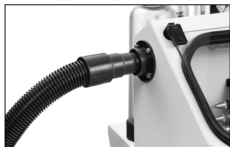
L'aspiratore PRO-3 può essere collegato in due modi diversi: **in alto a sinistra** per asportare solo la parte polverosa e leggera, in questo caso inserire il bocchettone nel collettore nero; oppure **nella parte bassa posteriore**, in questo modo l'asportazione riguarda anche tutto l'abrasivo utilizzato. In qualsiasi caso rimuovere o spostare i tappi
