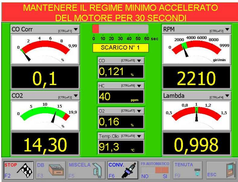
Se il veicolo possiede più di un tubo di scarico, sarà effettuata una prova per ognuno di loro ed il risultato sarà la media di tutte le prove. Per le autovetture catalizzate occorrerà effettuare una seconda prova al minimo accelerato.
