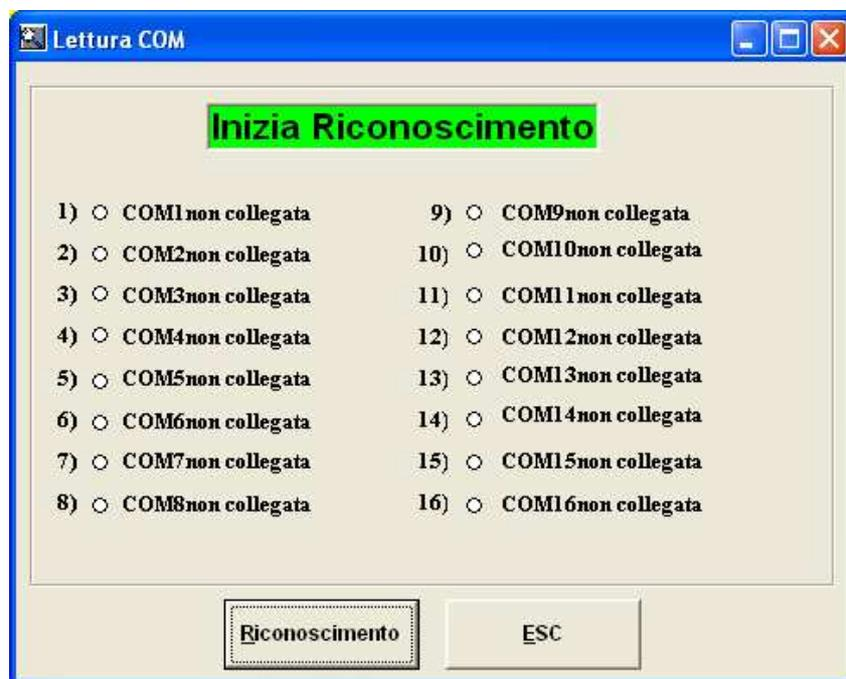
Selezionare **Lettura COM** nel menù **Utilità** per attivare la ricerca automatica degli strumenti Assemblad connessi al PC, questa funzione serve per acquisire i dati per le impostazioni di set-up e per la verifica della comunicazione con gli strumenti.
