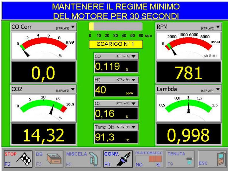
All'avvio della prova sarà eseguito un autozero al termine del quale inizierà la prova al minimo.
