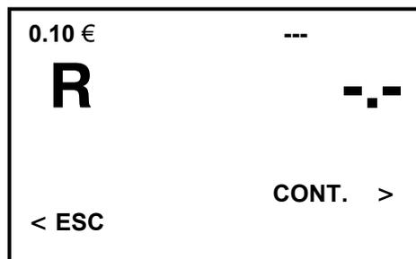
Premendo il tasto attivo 1, una terza volta, viene visualizzato il valore 0.20 € questo invece viene contabilizzato nelle rimanenze e appare il seguente display
