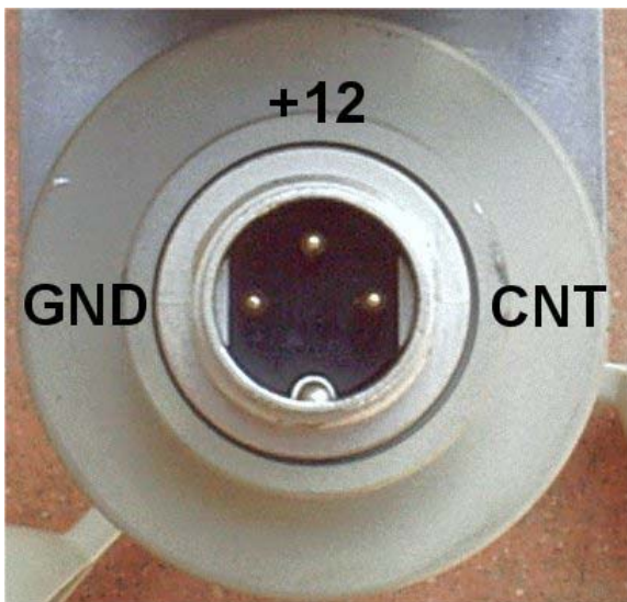
Fig. 4 – Connessioni del sensore anemom.
