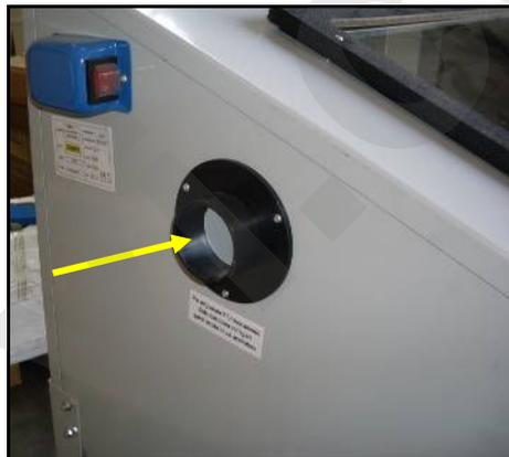
Figura 10 - Attacco al sistema di aspirazione
