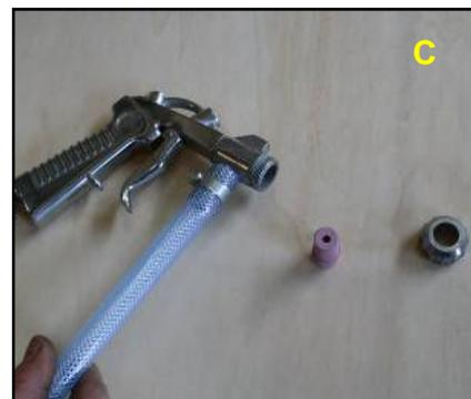
Figura 12 - Smontaggio dell'ugello della pistola sabbiatrice.
