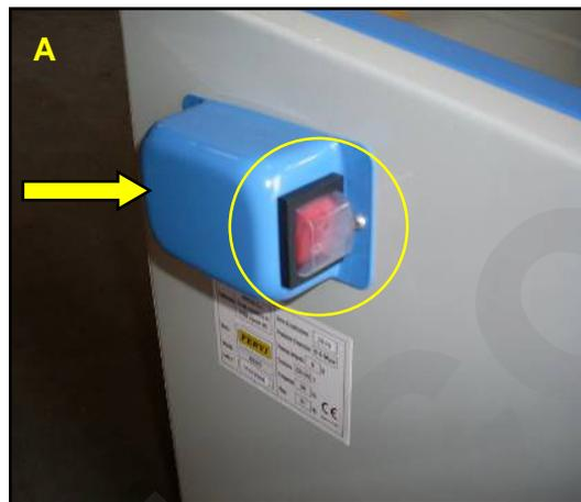
Figura 7 - Dettaglio interruttore e presa per spinotto.
