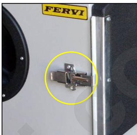
Figura 9 - Sistema di bloccaggio
