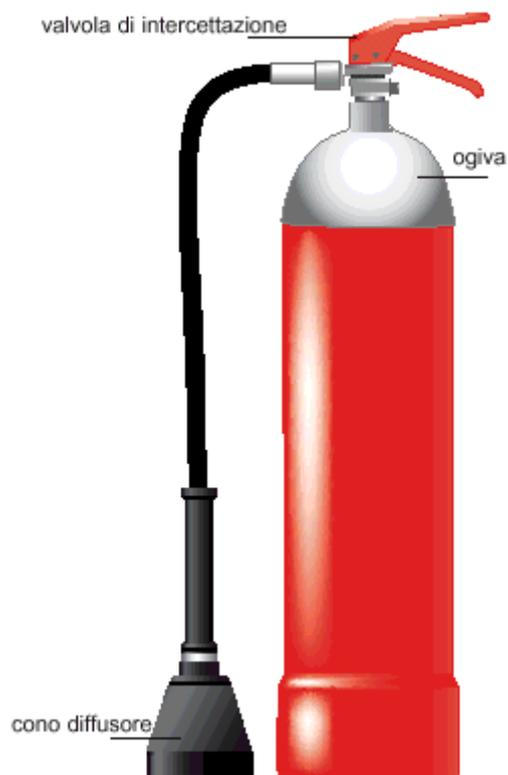
**SISTEMA DI EROGAZIONE:** LA PRESSIONE NECESSARIA ALL'EROGAZIONE È QUELLA STESSA DI COMPRESSIONE DEL GAS.
