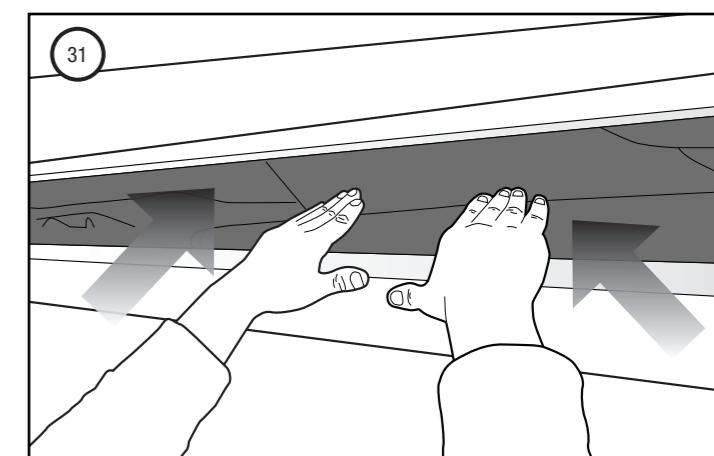
Prima di completare la chiusura (a una distanza di 10-15 cm fra i gusci) è necessario inserire il tessuto all'interno della tenda.
