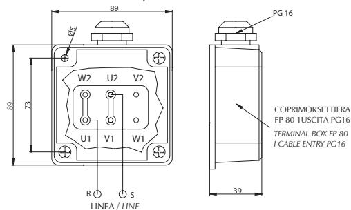
COLLEGAMENTO DELLA MORSETTIERA CON IL MOTORE PER ROTAZIONE ORARIA
