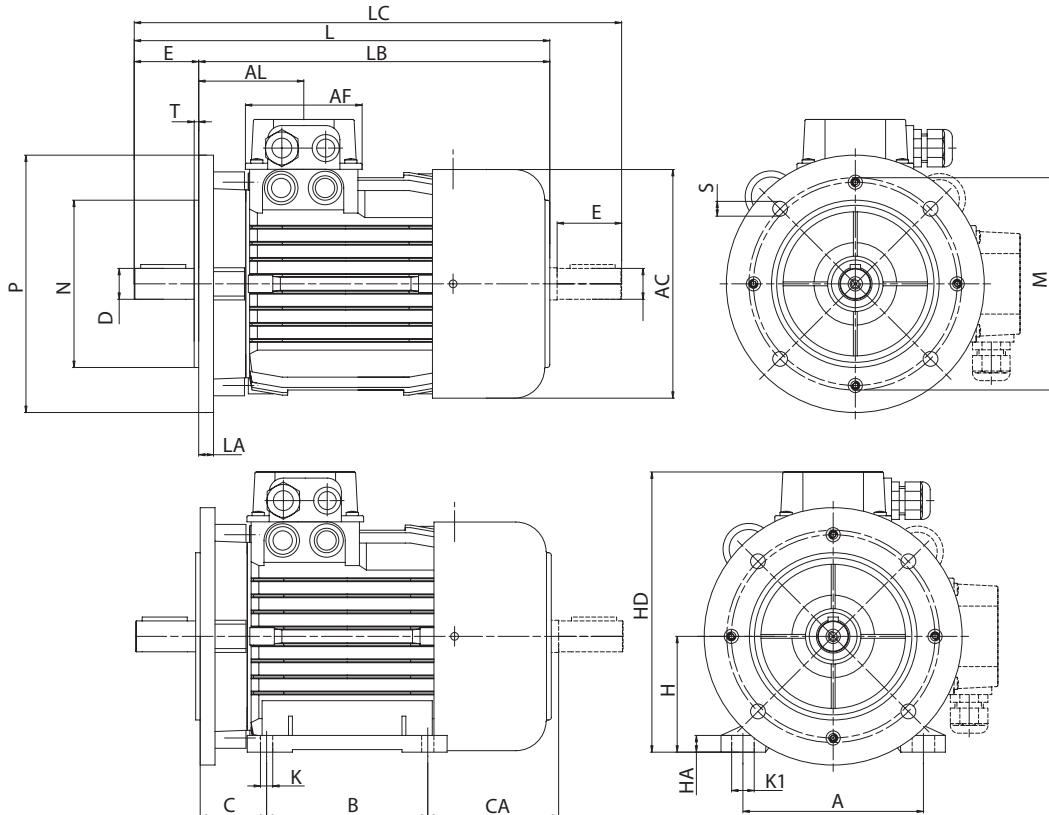
Il tratteggio nel disegno indica i condensatori montati sulle serie MM e MMK.
