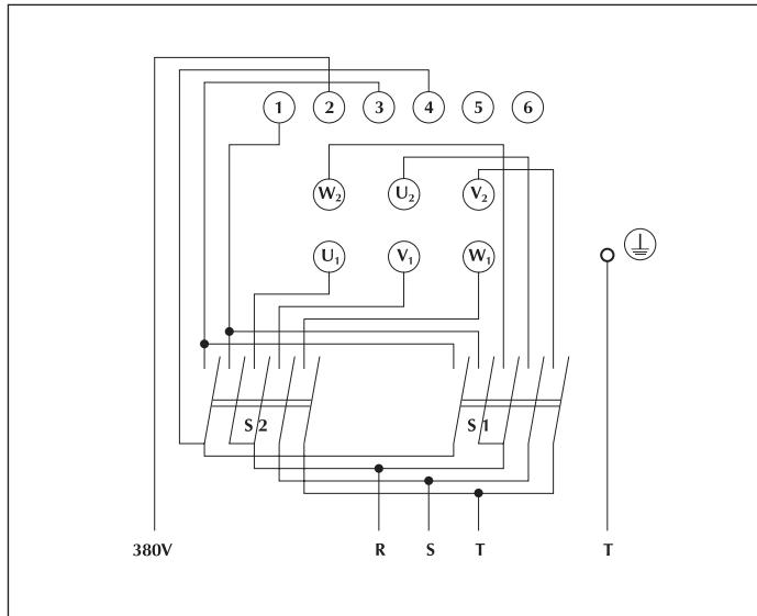
Collegamento per frenata rapida. Al raddrizzatore 380 V~.
