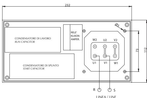
COLLEGAMENTO DELLA MORSETTIERA CON IL MOTORE PER ROTAZIONE ORARIA
