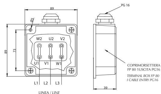
COLLEGAMENTO DELLA MORSETTIERA CON IL MOTORE PER ROTAZIONE ORARIA
