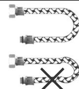
Prima dell'inizio della curvatura lasciare un tratto rettilineo di almeno 1.5 - 2 volte il diametro esterno.
