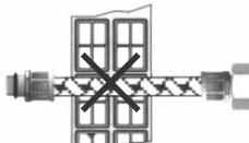
Avvitare i raccordi con tenuta oring a mano coppia massima di serraggio 3 Nm.
