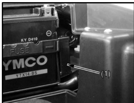
(1) Vano porta fusibili 10-15 A
