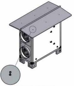
Fissare il tetto alla struttura in alluminio con le viti e le rondelle a tenuta in dotazione Fix the canopy on aluminium structure with screws and washers provided
