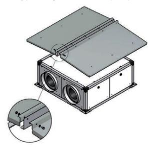
Assemblare tra di loro le due falde del tetto frapponendo il distanziale come indicato in figura Assemble together the 2 parts of canopy interposing the component indicated on the drawing
