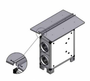
Assemblare tra di loro le due falde del tetto frapponendo il distanziale come indicato in figura Assemble together the 2 parts of canopy interposing the component indicated on the drawing
