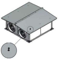
Fissare il tetto alla struttura in alluminio con le viti e le rondelle a tenuta in dotazione Fix the canopy on aluminium structure with screws and washers provided
