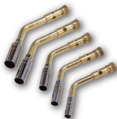
Lancia speciale con fiamma avvolgente, ideale per brasature dolci e forti dei tubi, grazie al riscaldamento omogeneo e più rapido del pezzo. Per gas propano alla pressione di 2 bar. Attacco entrata M14 x 1.
