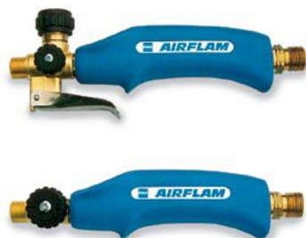
Le impugnature AIRFLAM sono costruite in materiale plastico antiurto. Permettono il montaggio rapido di tutti gli accessori illustrati. Pressione max di alimentazione propano = 4 bar. Attacco di entrata G 3/8 sinistro da completare con dado e portagomma G 3/8. Attacco di uscita M14 x 1.
