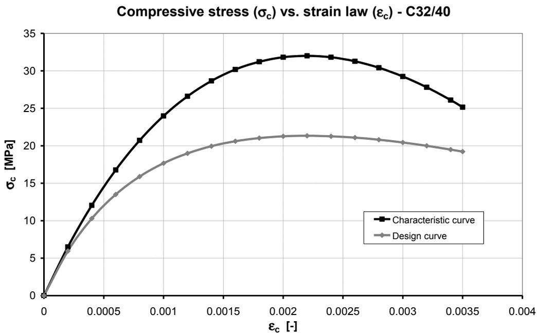
Figura A.1. Legame sforzo-deformazione a compressione del calcestruzzo fibrorinforzato.
