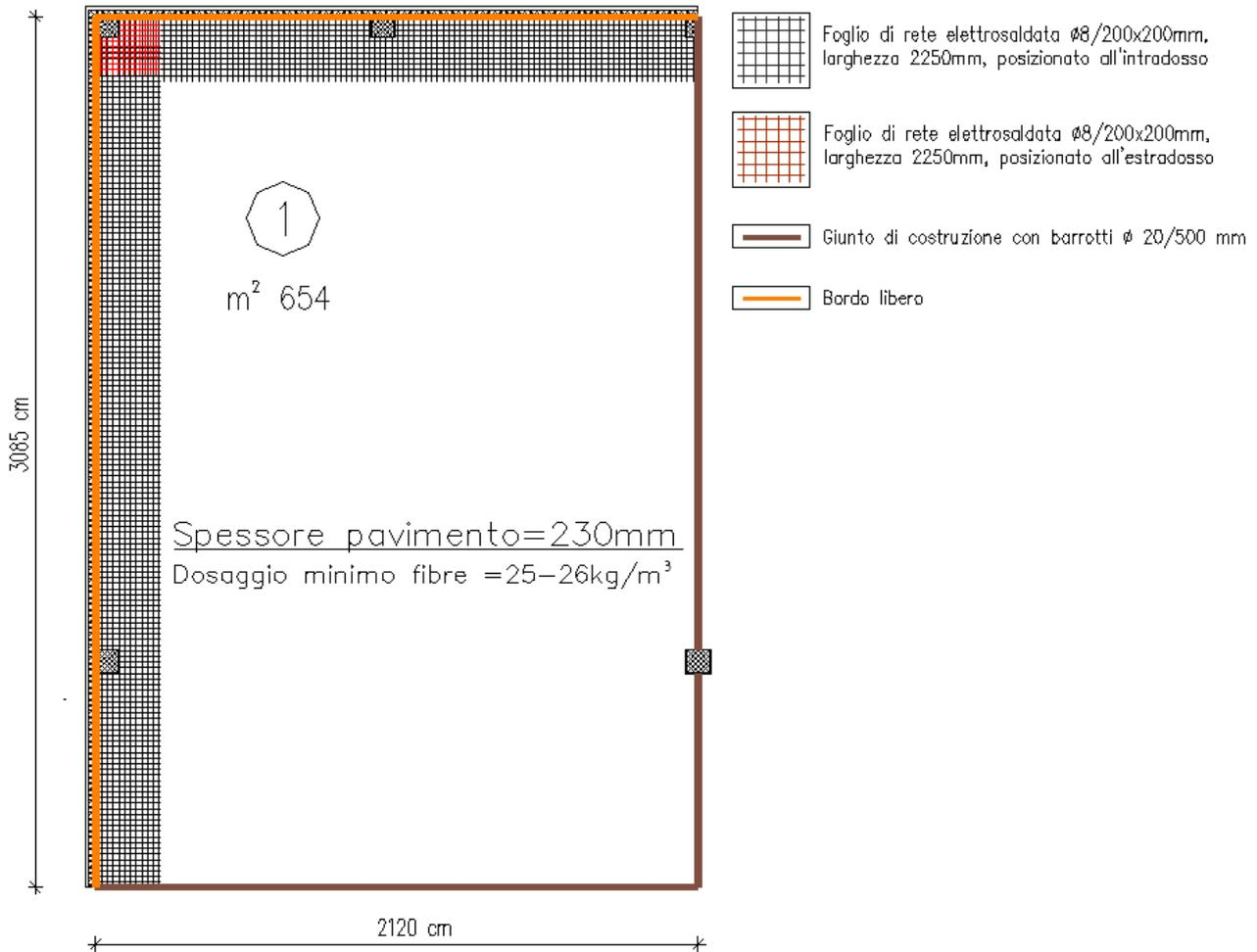
**Figura B.6.** Principali caratteristiche del campo di pavimentazione del Campo 1.
