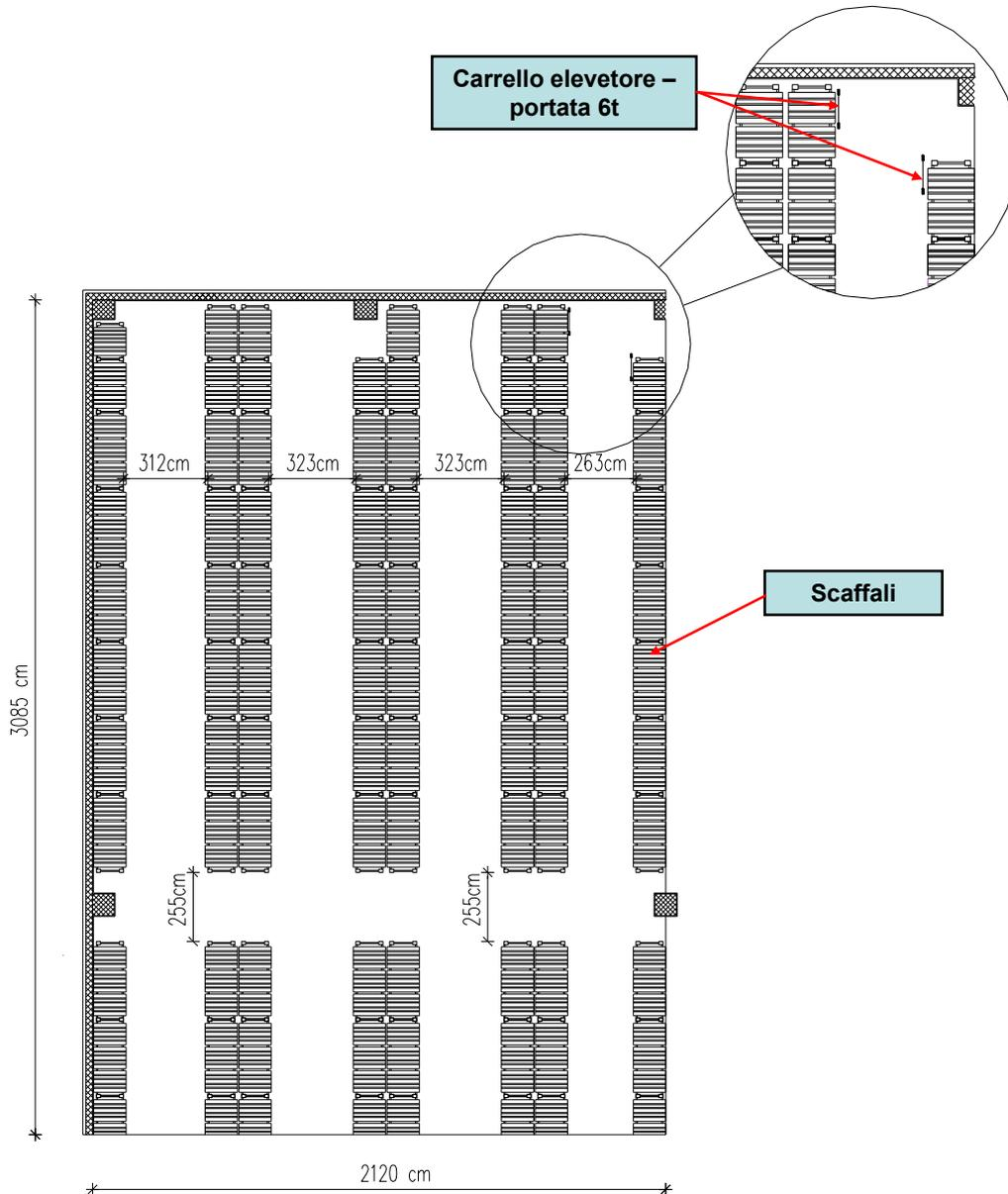
**Figura B.10.** Campo di pavimentazione n°1 del blocco 2: disposizione dei carichi considerati nell'analisi numerica.
