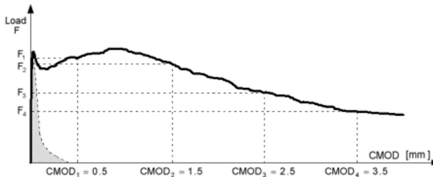
**Figura 4.1.** Tipica curva  $F - CMOD$  determinata da una prova di flessione UNI EN 14651 su un provino di calcestruzzo fibrorinforzato, posta a confronto con l'analogo risultato in assenza di fibre.
