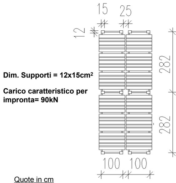
**Schema impronte ruote del carrello elevatore**
