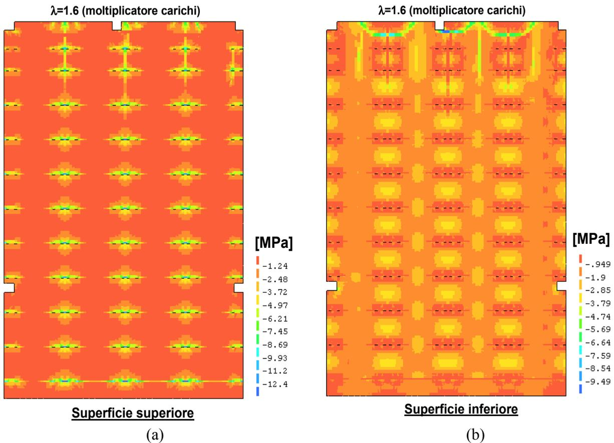
Figura B.13. Campo di pavimentazione n°1: contour degli sforzi principali minimi rilevati sulla superficie superiore (a) e inferiore (b) della pavimentazione in corrispondenza di un moltiplicatore dei carichi  $\lambda=1,6$ .
