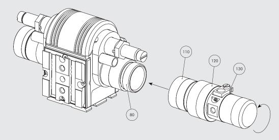
Su un singolo DAPK-2/DAPIK-2 è possibile montare uno o due accessori Battuta intermedia DZAK-2 ottenendo così una terza e una quarta posizione di lavoro dell'attuatore rotante.
