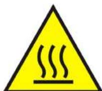
**Situazioni di pericolo:** quando si transita o lavora nelle vicinanze di attrezzature che producono calore (lance termiche, fiamma ossidrica, saldatrici, ecc.) o macchine funzionanti con motori (generatori elettrici, compressori, ecc.); quando si effettuano lavorazioni con sostanze ustionanti. Spegner l'attrezzatura o il motore delle macchine se non utilizzate.
