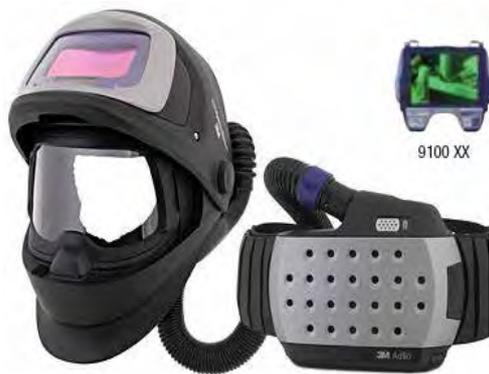
Gli schermi per saldatura Speedglas in combinazione con il respiratore Adflo formano un sistema integrato leggero e compatto. Respiratore motorizzato Adflo™. Il sistema di flusso d'aria consente la distribuzione uniforme dell'aria filtrata sull'intera area. E' possibile aumentare il flusso dell'aria da 170 l/min a 200 l/min. Regolazione automatica 9/13 in 0,1 millesimi di secondo. Extra display 73x107.
