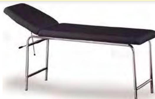
Struttura in tubo d'acciaio e gambe smontabili in tubolare a sezione tonda. Sistema di sollevamento della testata azionato mediante dispositivo a scorsoio con regolazione autobloccante. Le parti imbottite sono di gommapiuma incollate su supporti in legno truciolare e ricoperte in skai lavabile autoestinguente.
