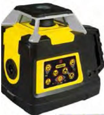
Rotante autolivellante. Livellamento orizzontale, verticale, squadri e scanning. Precisione: ± 1,5 mm a 30 metri. Raggio di utilizzo: fino a 200 metri. Allarme ADS per segnalare quando lo strumento viene mosso. Vel. di rotaz.: 600 giri/min. Protezione a pioggia e polvere (norme IP66). **Include: ricevitore, target, caricabatterie, pacco batterie ricaricabili, manuale, valigetta per il trasporto.** **Imballo: 1/1.**
