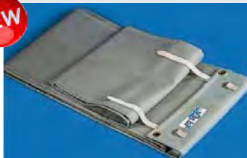
Copertura speciale di protezione per il raffreddamento controllato delle saldature dei tubi. Previene dagli shock termici e protegge da agenti esterni il cordone di saldatura. Sistema di aggancio e sgancio rapido con cinghia e fibbia di fi ssaggio. Rivestito esternamente in poliuretano idrorepellente, tessuto interno resistente fino a 600°C. Larghezza standard 300mm, diametri variabili da 200 fi no a 1400mm. Imballo: 1/1.
