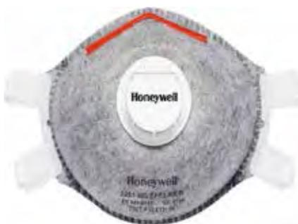
Maschera ai carboni attivi FFP2D-OV. Protezione contro polveri, fumi e aerosol a bassa e media tossicità. Il facciale filtrante è inoltre idoneo in caso di esposizione a livelli di gas e vapori organici al di sotto del 12TLV: il facciale filtrante allevia il fastidio degli odori da essi generati. Guarnizioni di tenuta a polo, elastici regolabili; con valvola. Indicata per lavori di saldatura. **A norma EN 149:01**
