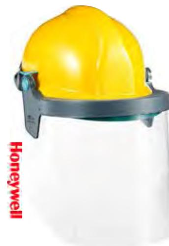
Aggancio con fascia elastica, si adatta ai più diffusi tipi di elmetto. I materiali resistono all'attacco di numerosi solventi, acidi e alcali. Resistente all'impatto (120m/s). Idoneo in metallurgia, industria chimica, costruzione. Adatto ai lavori di saldatura a fiamma se combinato con uno schermo oscurato. (Schermo a parte).
