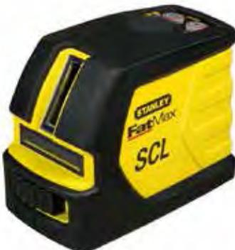
Autolivellante, proietta una linea orizz. ed una linea vert. a 90° rispetto alla linea orizzontale. Ampiezza delle linee fino a 130°. Funzione luce pulsante per utilizzo con ricevitore per lavori in esterno. Diodi Laser 635 Nm - classe 2. Precisione ± 3 mm a 15 metri. Portata fino a 10 metri in interni (25 con ricevitore). La conf. include; bersaglio, occhiali, mini treppiede, supporto, batterie, manuale, borsa per il trasporto.
