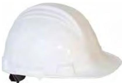
Elmetto in HPDE (polietilene ad alta densità). Bardatura tessile a 6 punti di attacco. Regolatore posteriore a cremagliera, fascia antisudore. Isolamento elettrico fino a 1000 V, Resistenza all'impatto fino a -30°C + 50 °. •Peso: g 379. Taglia: unica.
