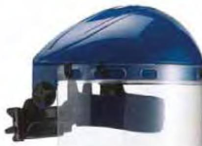
Realizzata in materiale anallergico, fascia frontale in spugna antisudore, Regolaz. sup.c/fascia passo passo, circonferenza cranica tramite cremagliera, Ribaltabile di 90° tramite frizioni, Peso grammi 29, Protettiva da particelle solide e schizzi chimici. (visiera a parte art.UNI.607010022 trasparente). **EN166. Imballo: 1/60.**
