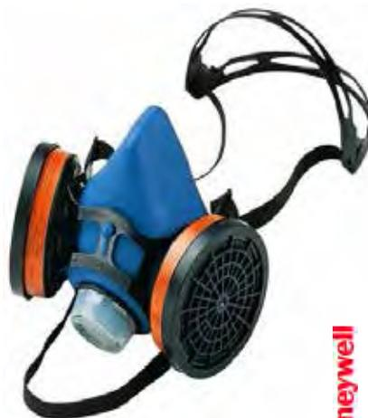
Morbida e confortevole, priva di silicone, triplice guarnizione di tenuta quindi maggiore igiene e sicurezza. Si caratterizza per un basso punto di appoggio sul naso e una bardatura pratica e facilmente regolabile. Extra leggera solo 109 gr. Può montare filtri con raccordo a baionetta. (Filtri separati). Ideale per lavorazioni meccaniche, chimiche, etc.. CE EN 140.
