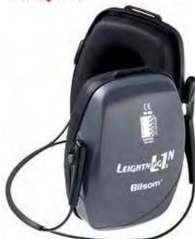
La tecnologia Air Flow Control™, consente di ottenere un'ottima attenuazione su tutte le frequenze, senza incrementare il peso o la dimensione delle coppe. Il suono penetra nelle coppe, e grazie ad una speciale piastra unita ad uno strato di tessuto non tessuto, viene filtrato in modo controllato. Il risultato è una migliore attenuazione su tutto lo spettro delle frequenze, adatta a qualsiasi tipo di rumorosità.
