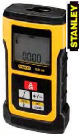
Portata: da 10 cm a 50 metri. Schermo a due linee. Precisione tipica: ± 1,5 mm. Funzioni: distanza, area, volume, Pitagora (due / tre misure ausiliarie), misura minima/massima, addizione e sottrazione. Raccordo terminale pieghevole multifunzione - permette la misurazione precisa di angoli e infissi. Schermo e tastiera impermeabilizzati. Allarme sonoro che evidenzia le misurazioni effettuate. La confezione include: batterie, manuale, fodero agganciabile alla cintura. **Imballo: 1/1.**
