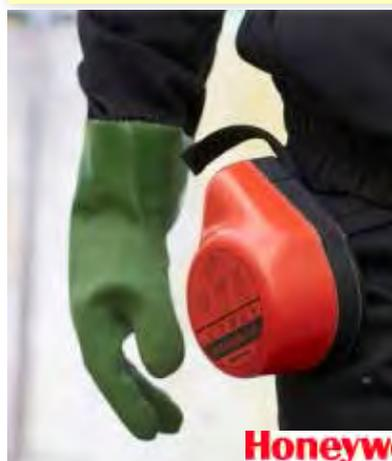
Semimaschera filtrante d'emergenza leggera e compatta da 15 minuti, offre protezione durante l'evacuazione di aree accidentalmente inquinate in cui il volume di ossigeno nell'atmosfera sia superiore al 17%. E' particolarmente idonea nei settori chimico e petrolchimico. E' compatibile con occhiali o elmetti. Dimensioni ridotte che ne permette l'aggancio ai calzoni. Durata anni 12. (quattro anni senza manutenzione). Non efficace contro il monossido di carbonio. **DIN 58647 - 7.** Imballo: 1/1.
