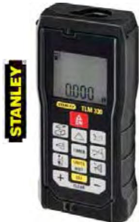
Portata: da 5 cm a 100 metri. Precisione: ± 1 mm. Funzioni: distanza, area, volume, calcolatrice, tracking, misurazioni parziali, Pitagora (3 funzioni), angoli. 20 valori in memoria. Raccordo terminale pieghevole per misurazioni dagli angoli. Schermo e tastiera impermeabilizzati. Allarme sonoro - evidenzia le misurazioni effettuate. Con fodero. **Imballo: 1/1.**
