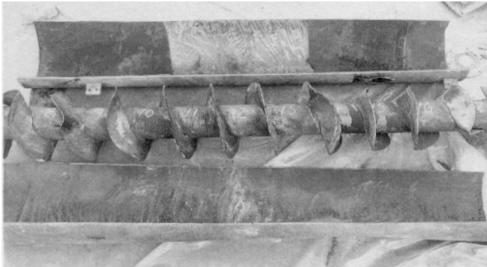
Fig.25 Coclea deformata a seguito dell'esplosione
