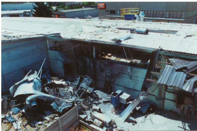
Fig. 21 Impianto di aspirazione esploso visto dall'alto
