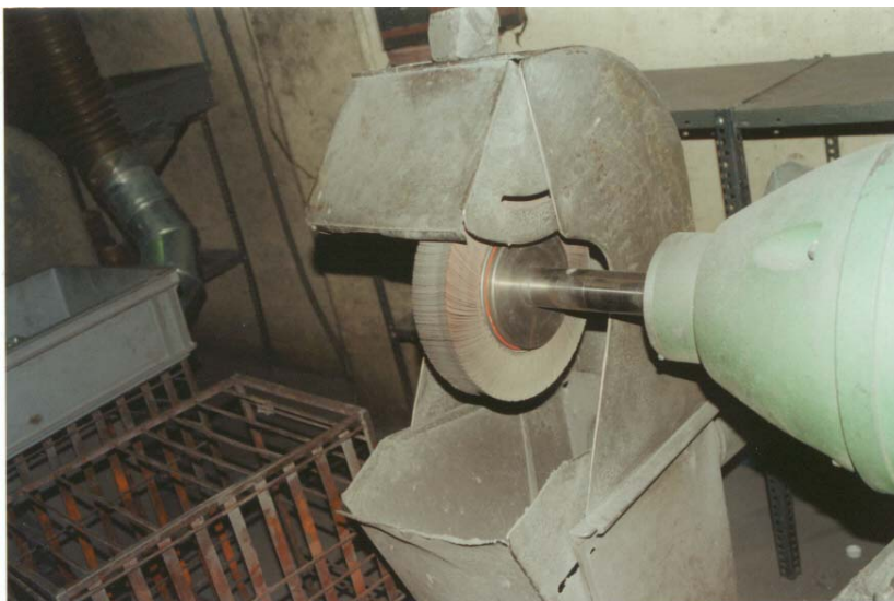
Fig.33 Mola circolare a lamelle
