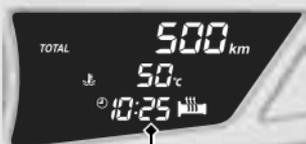
**Orologio (visualizzazione 12 ore) e durata del percorso e livello del riscaldatore delle manopole del manubrio**
