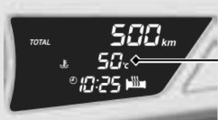
**Indicatore del consumo chilometrico istantaneo e Velocità media e Indicatore temperatura liquido di raffreddamento e Indicatore temperatura aria esterna esterna**
