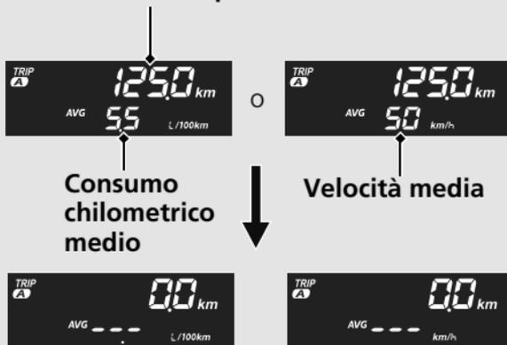
Per effettuare l'azzeramento simultaneo di contachilometri parziale B, consumo chilometrico medio e velocità media (tutti basati sul valore riportato sul contachilometri parziale B), tenere premuto il pulsante **A** quando sul display viene visualizzato il contachilometri parziale B.
