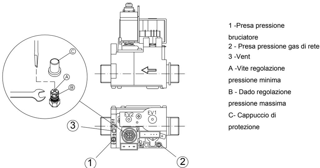
Per eseguire il controllo delle pressioni al bruciatore, inserire le sonde del manometro nelle prese di pressione disponibili sulla valvola gas (vedi fig.).
