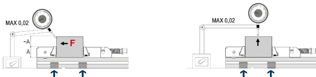
MORSA ANCORATA CON 2 COPPIE DI STAFFE ART. 296 / VISE CLAMPED WITH N. 2 PAIRS OF ART. 296
