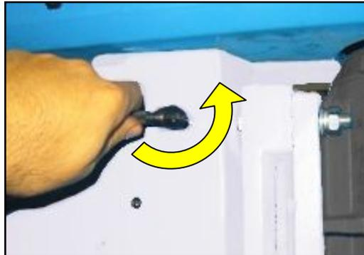
Figura 8 – Svitare le viti di bloccaggio
