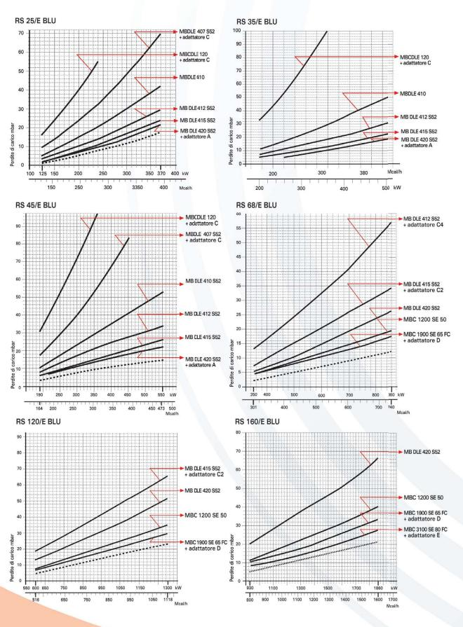
I diagrammi indicano le perdite di carico minime dei bruciatori con le varie rampe gas abbinabili omologate secondo norma EN 676.
