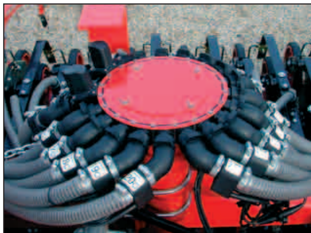
Distributori con saracinesche per le corsie di marcia e sensori del flusso di sementi
