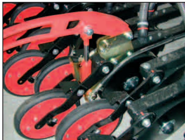
Regolazione dell'altezza del marcatore di mandata
