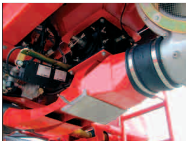
Dosatrice con paratia di scarico e disattivazione elettrica del semi-lato
