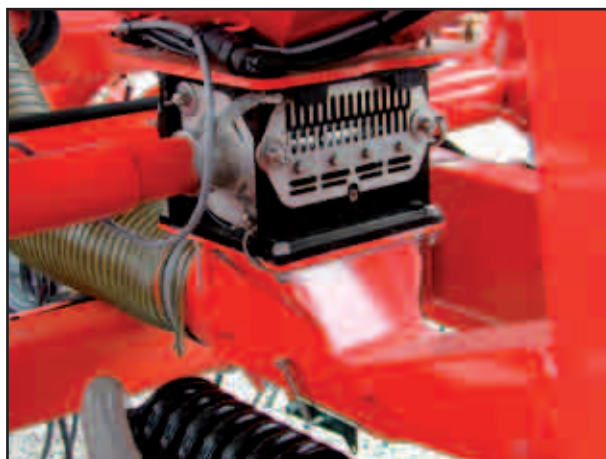
Dosatrice con coperchio per l'ugello iniettore
